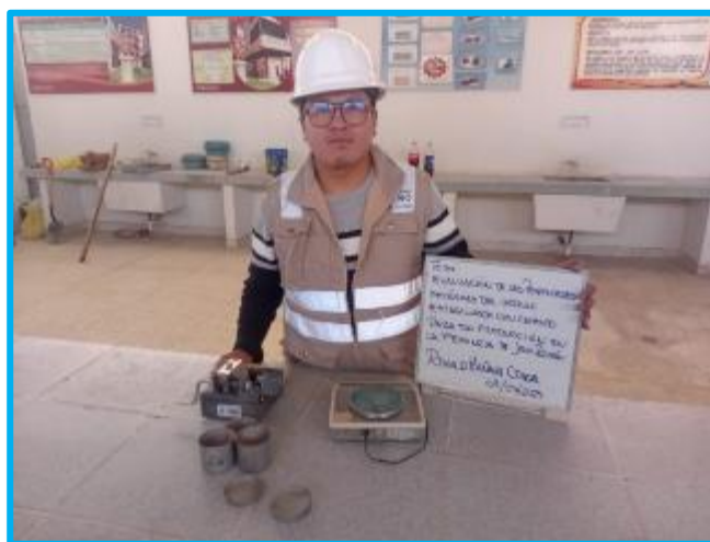
Fotografía 4. Determinación de los Límites de consistencia de la muestra.
