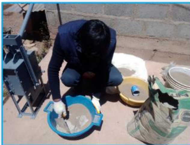
Fotografía 8. Proporciones de los materiales en la mezcla según los porcentajes establecidos.
