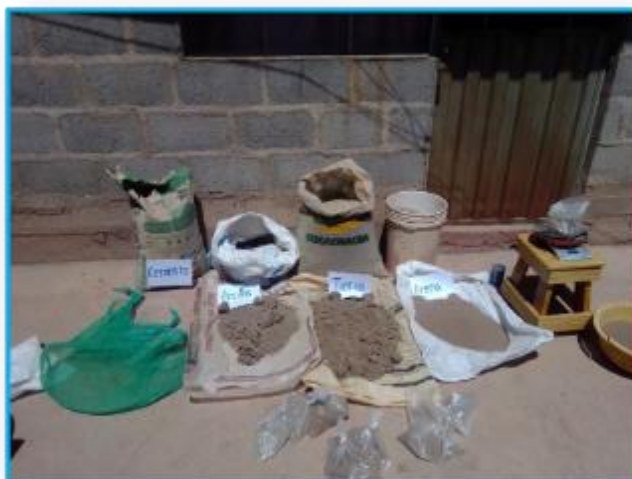
Fotografía 7. Materiales utilizados en la mezcla para el diseño de ladrillo estabilizado.
