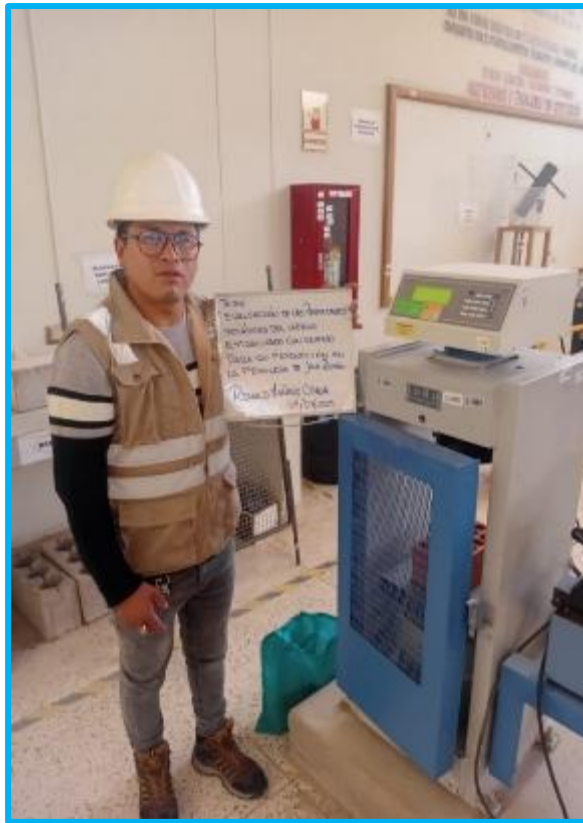
Fotografía 15. Ensayo de resistencia a la compresión en ladrillos estabilizados.
