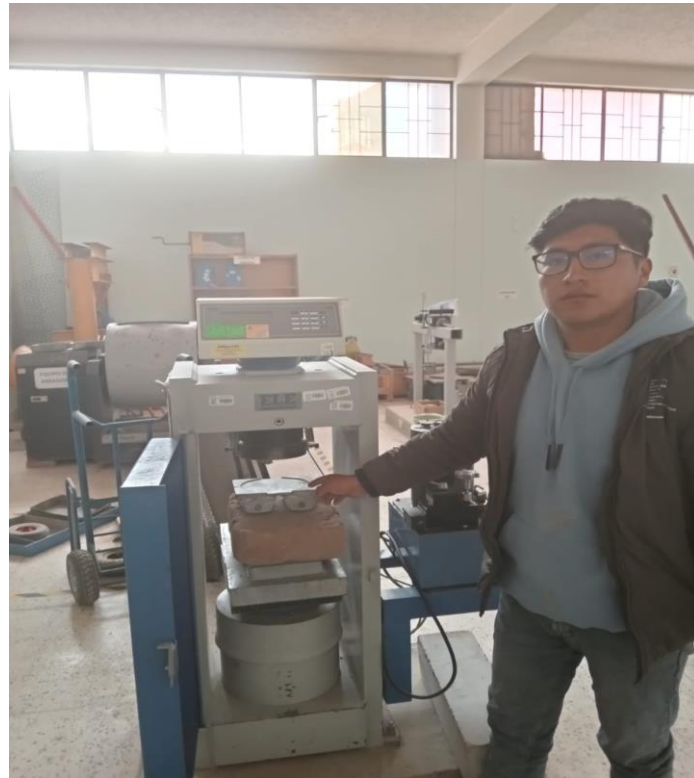
Fotografía 05. Ensayo de resistencia a tracción de los testigos
