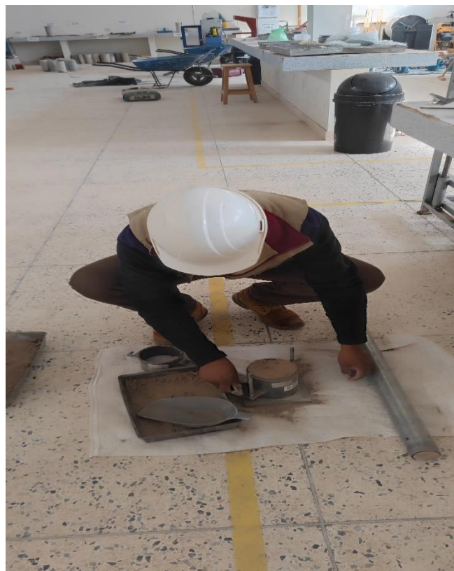
Fotografía 04. Alistado del material para los ensayos de compactación
