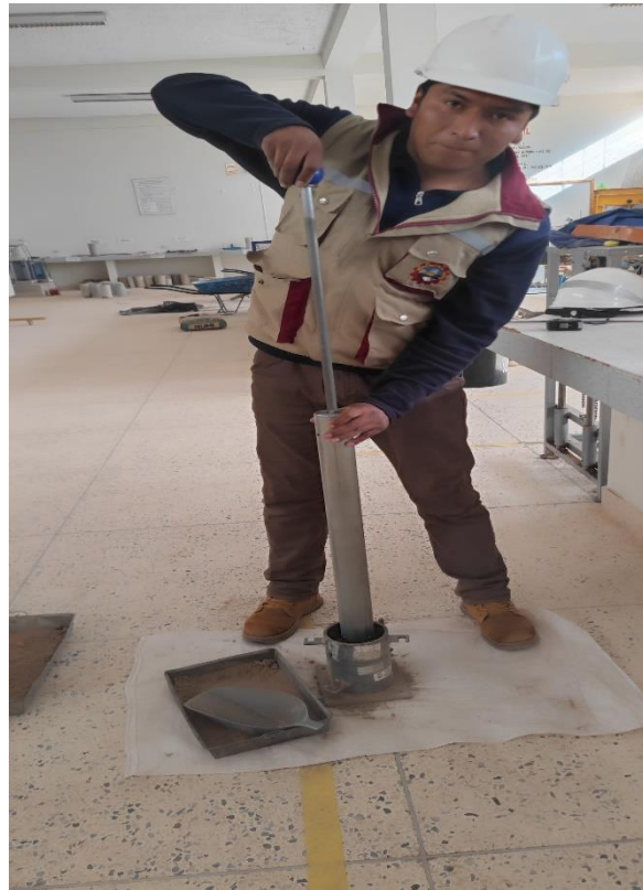
Fotografía 05. Ensayo de compactación de suelos
