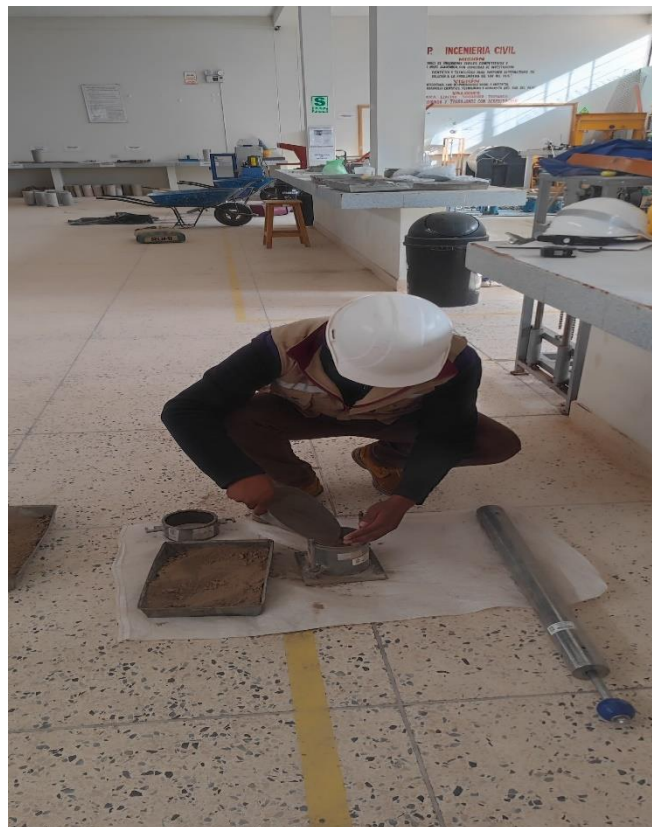
Fotografía 06. Relleno de la muestra para compactación
