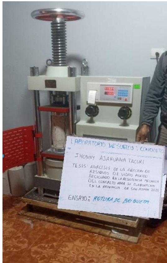
Fotografía 1. Prueba de resistencia a la compresión
