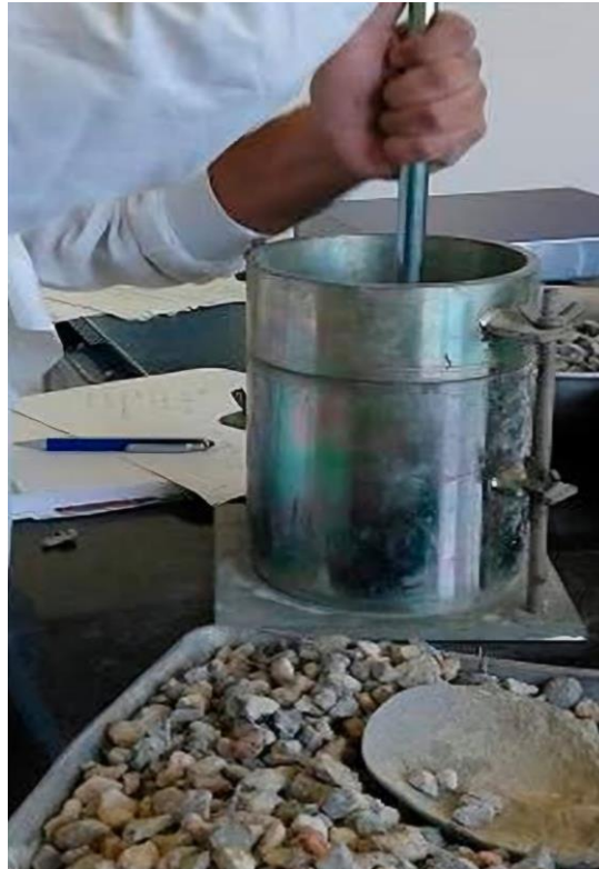
Fotografía 7. Procediendo a realizar el varillado del agregado grueso
