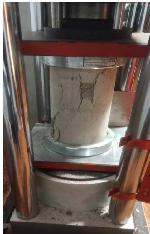
Fotografía 8. Ensayo de compresión de la probeta
