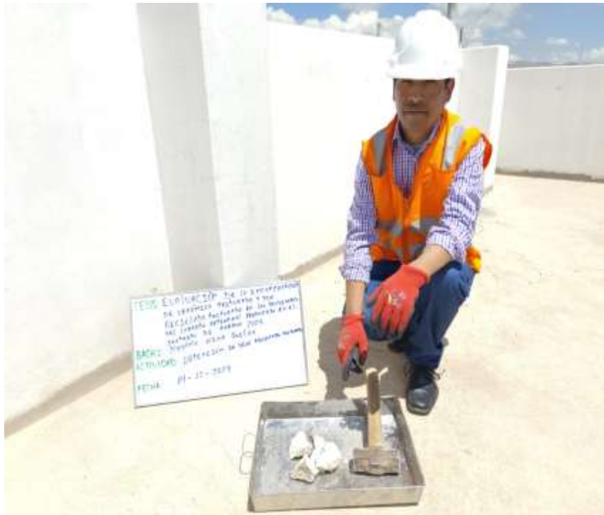
Fotografía 5. Trituración de yeso reciclado
