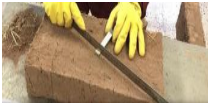
Prueba del alabeo
