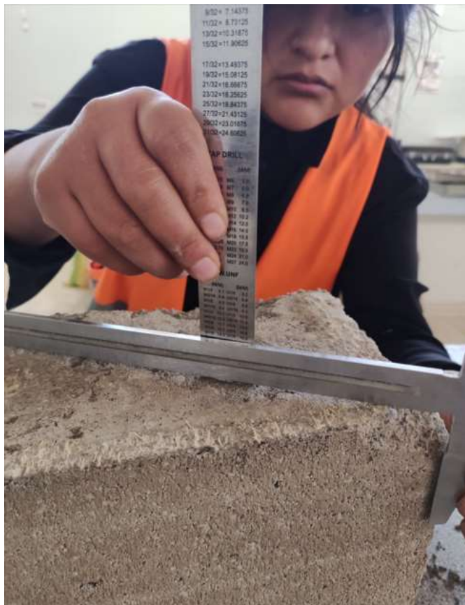
Fotografía N° 12: Llenado de muestra en el molde del Proctor modificado
