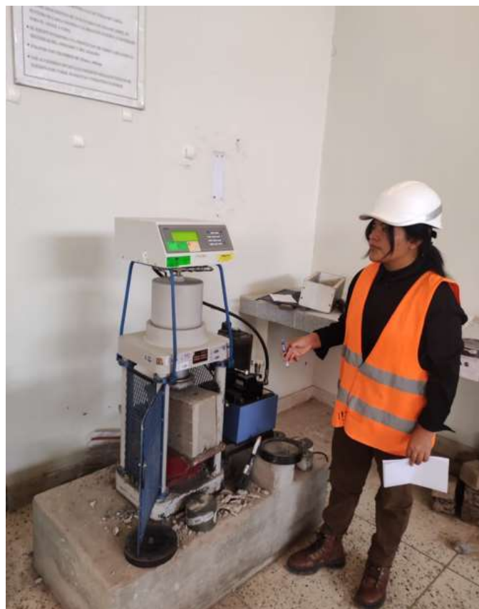
Fotografía N° 18: Medición de la expansión a cada 30 min.
