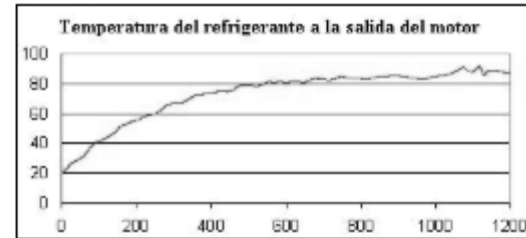
Figura 3. Simulación de la evolución de la temperatura de un motor durante su arranque bajo un ciclo, obtenida con un programa de simulación comercial NEDC.
