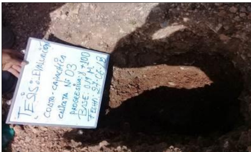
Fotografía 01. Sondeo en campo para el estudio de mecánica de suelos.
