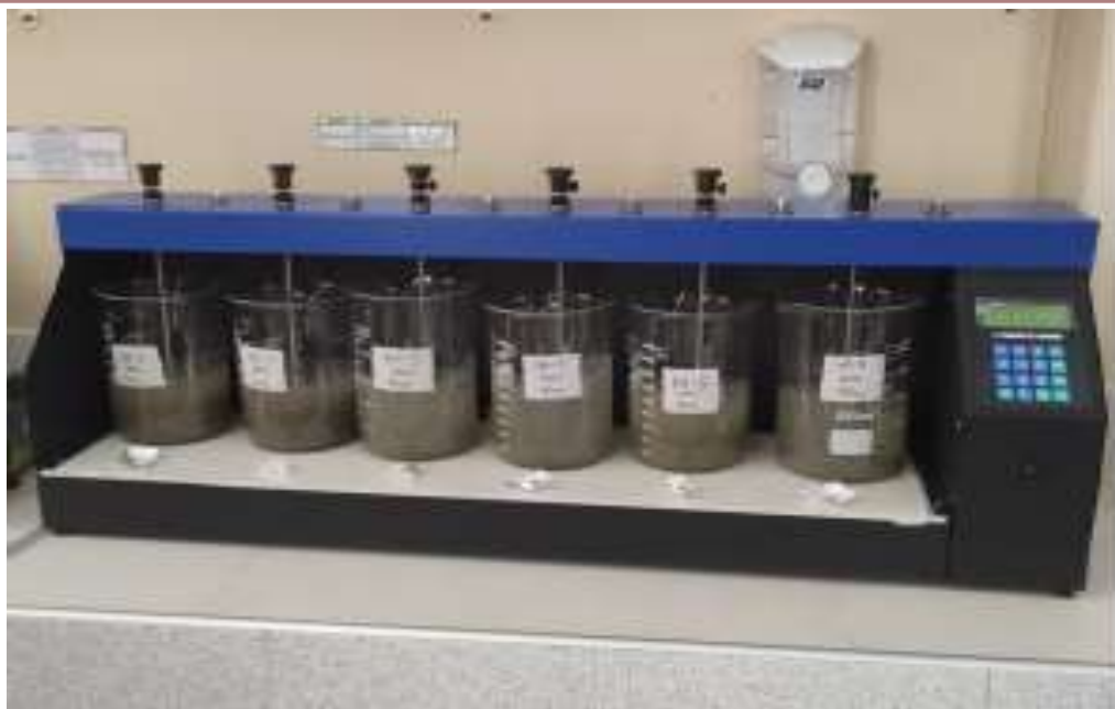
Fotografía 7. Pruebas de optimización de dosificación de floculante.
