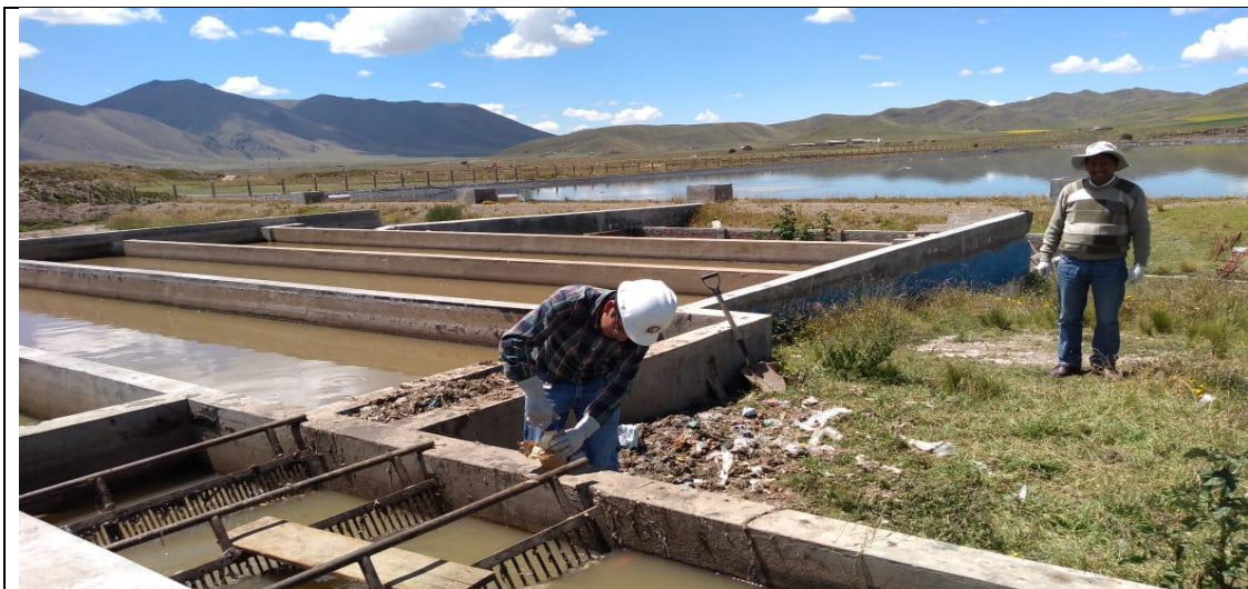
IMAGEN N° 03: Toma de muestra compuesta del agua residual en las siguientes coordenadas zona 19L ; 330251.47 m E; 8353026.44 m S
