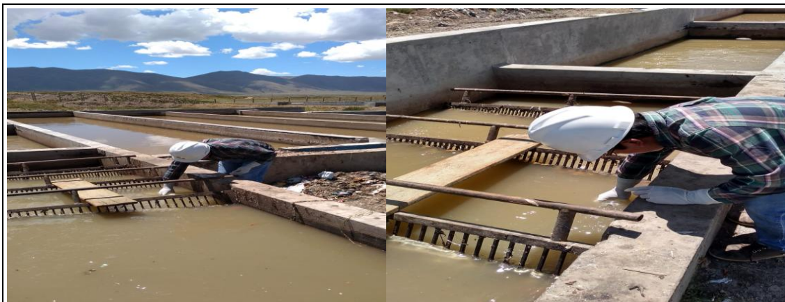
IMAGEN N° 01: Toma de muestra compuesta del agua residual en las siguientes coordenadas zona 19L ; 330251.47 m E; 8353026.44 m S.
