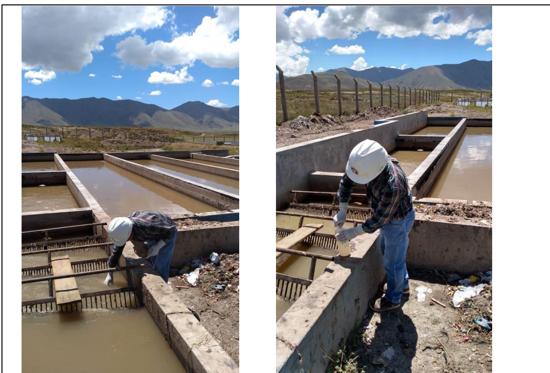
IMAGEN N° 04: Toma de muestra compuesta del agua residual en las siguientes coordenadas zona 19L ; 330251.47 m E; 8353026.44 m S
