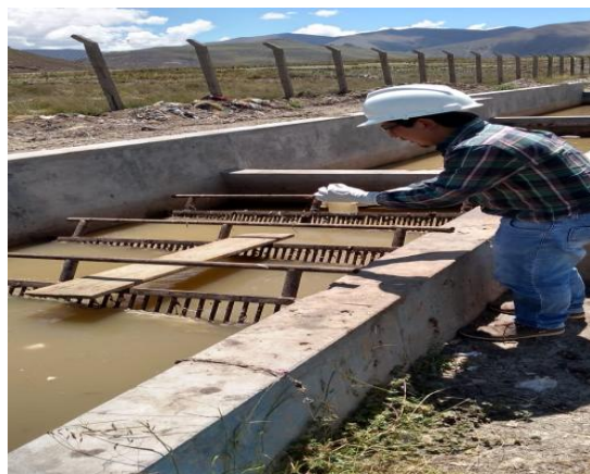
IMAGEN N° 02: Toma de muestra compuesta del agua residual en las siguientes coordenadas zona 19L ; 330251.47 m E; 8353026.44 m S.
