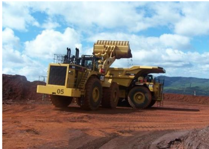
Figura 5 Pala mecánica y camión todoterreno 994
