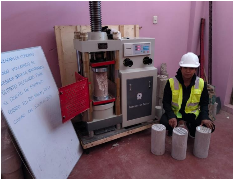
Fotográfico 3. Se muestra el ensayo de compresión a los 14 días.
