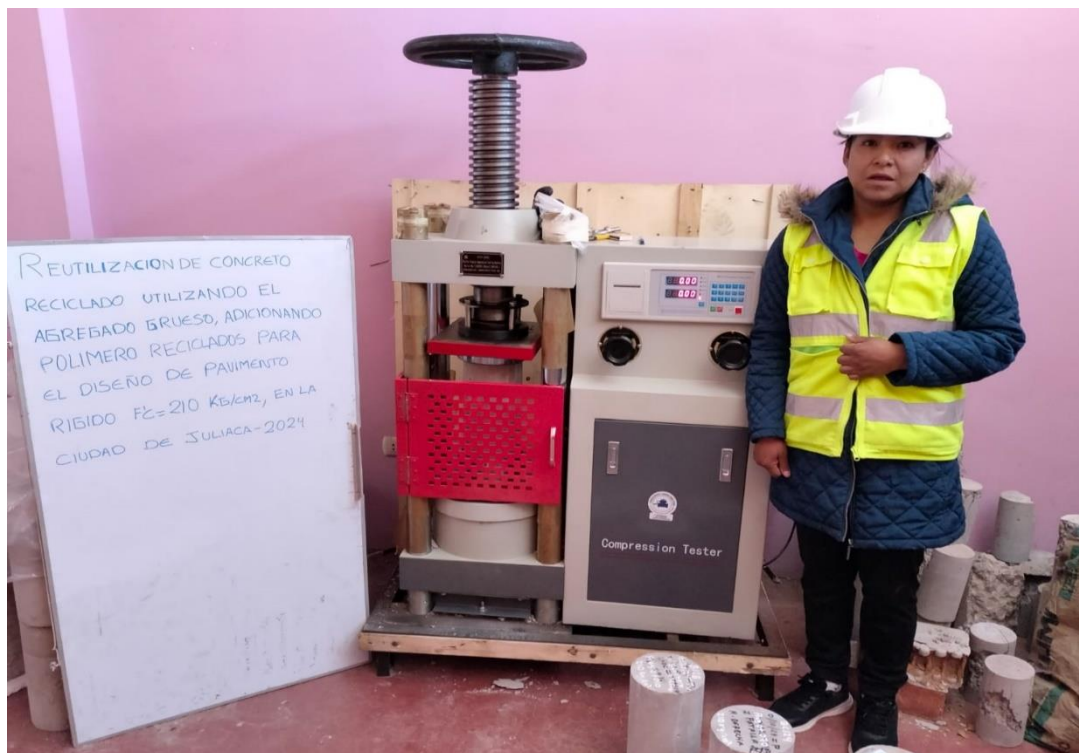
Fotográfico 4. Se muestra el ensayo de compresión a los 14 días.
