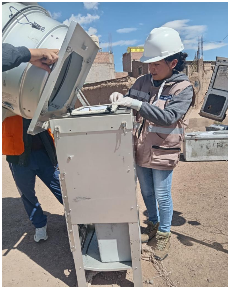
Fotografía 07. Extracción del filtro del equipo HI-VOL para observación y medición de material particulado
