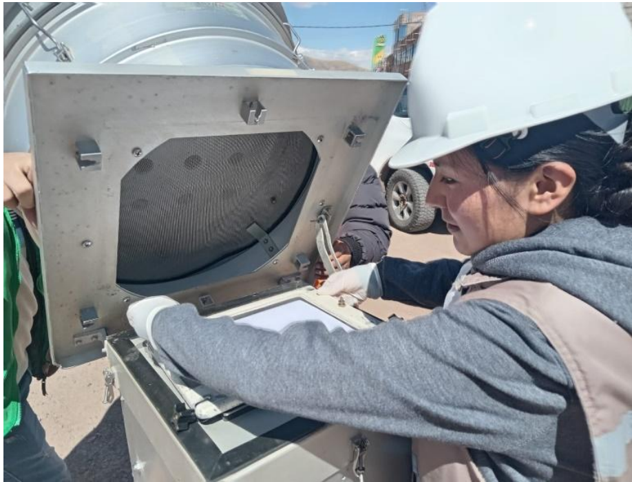
Fotografía 05. Colocación de filtros al equipo HI-VOL
