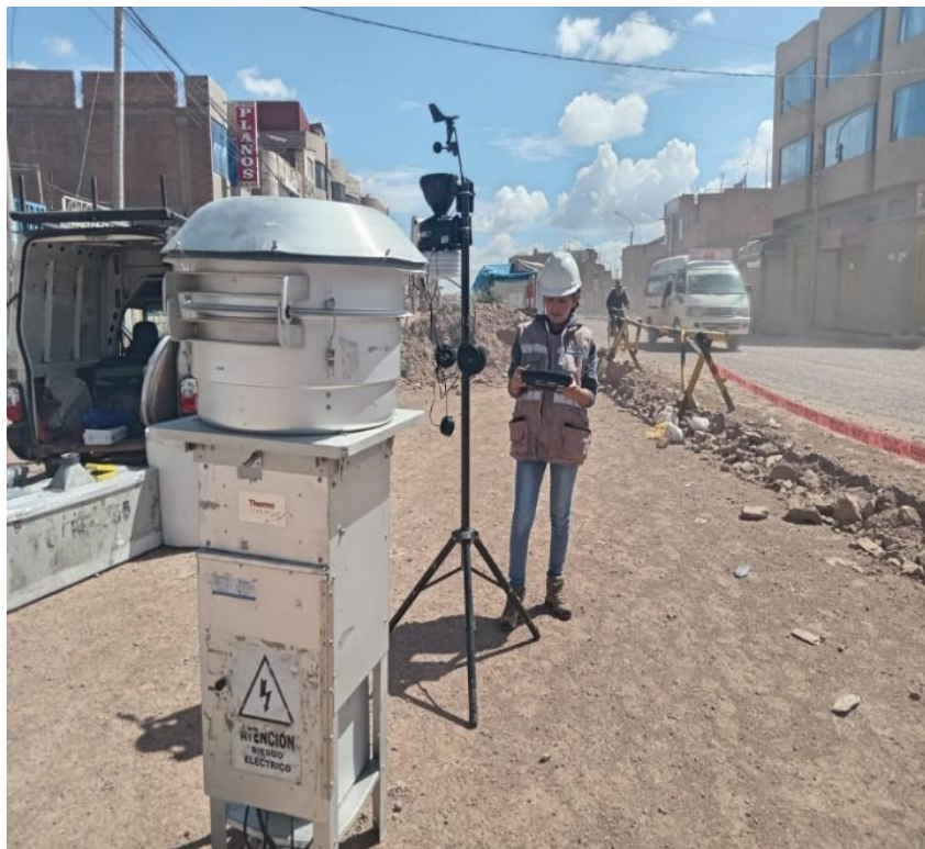
Fotografía 04. Ubicación de equipo HI-VOL y la Veleta
