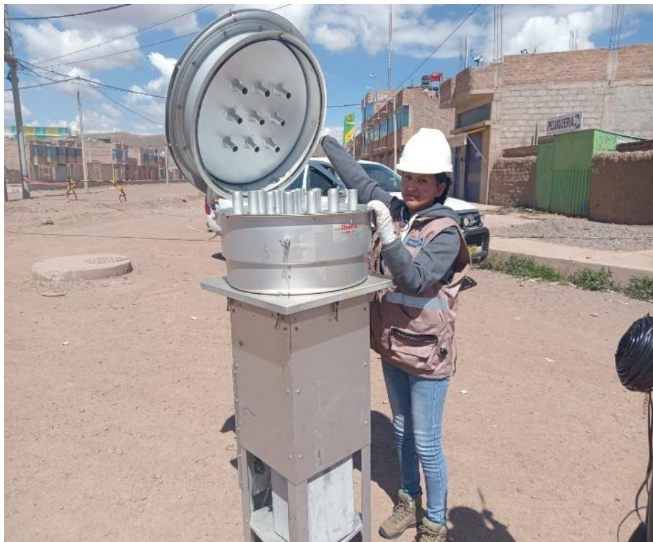
Fotografía 06. Cerrado de la tapa del equipo HI-VOL
