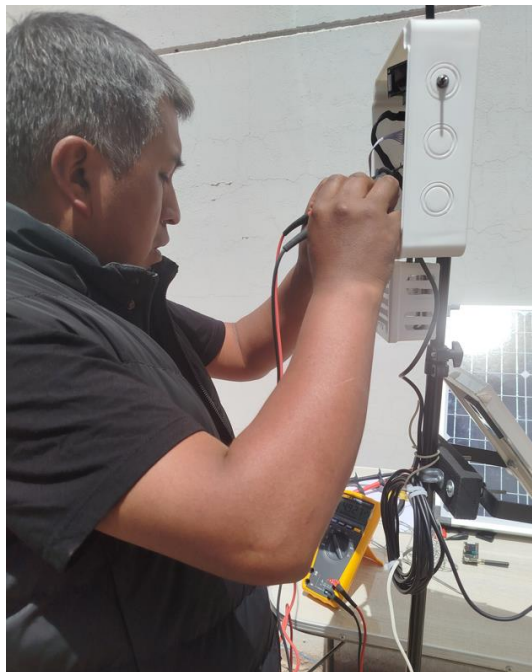
Muestras fotográficas: Tomas de muestras de voltaje y corriente con el multímetro Fluke 179 y el sistema propuesto.
