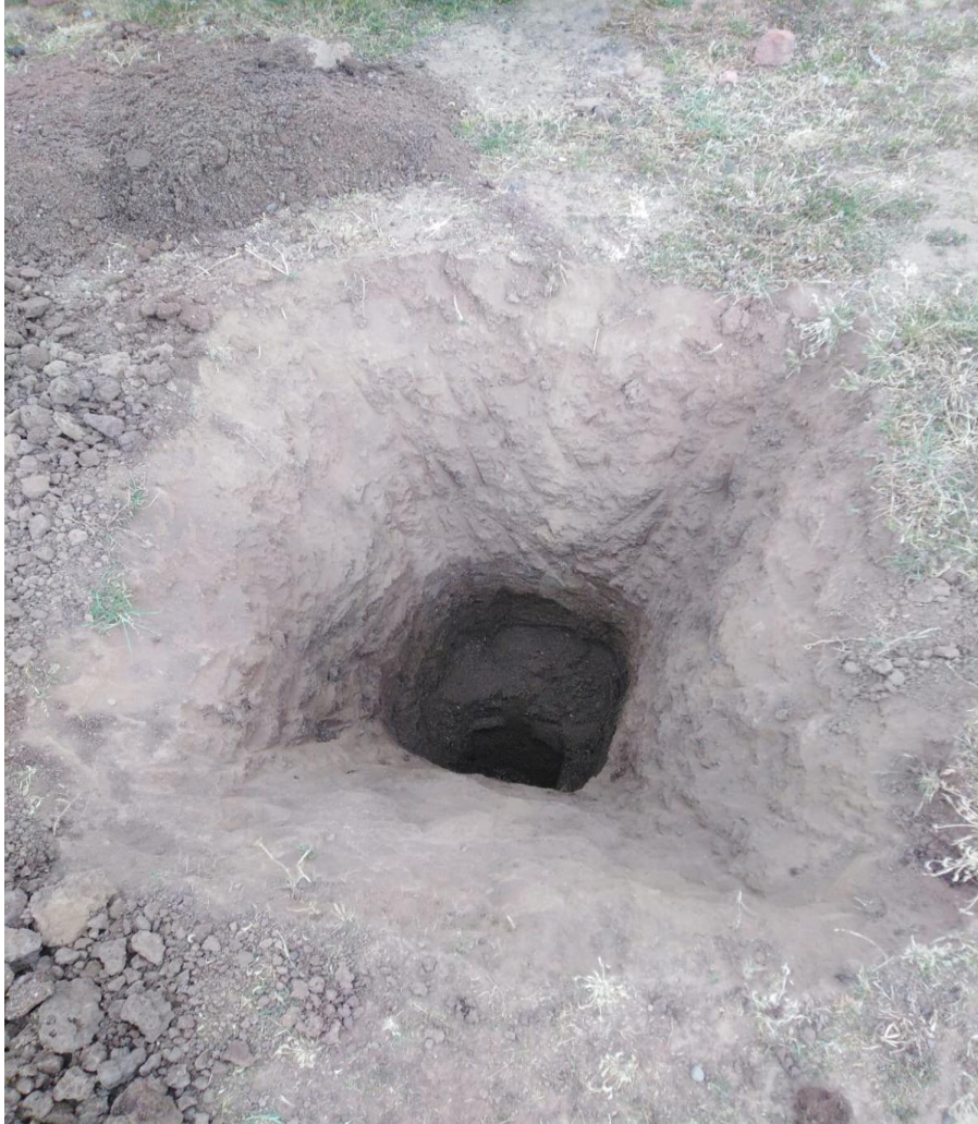
Fotografía 5. Prueba de infiltración.
