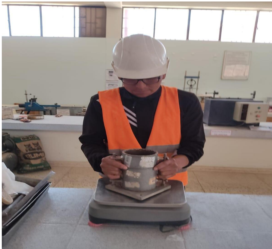
Fotografía 16. Pesaje del molde cilíndrico paso 1
