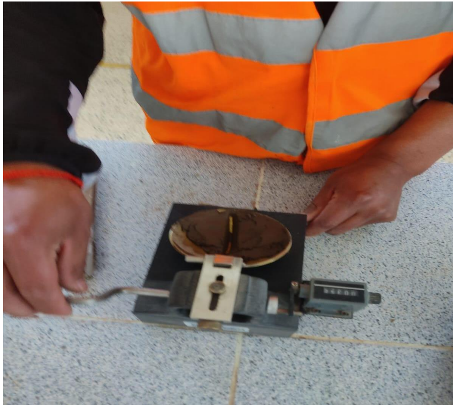
Fotografía 11. Ensayo de limite liquido paso 3
