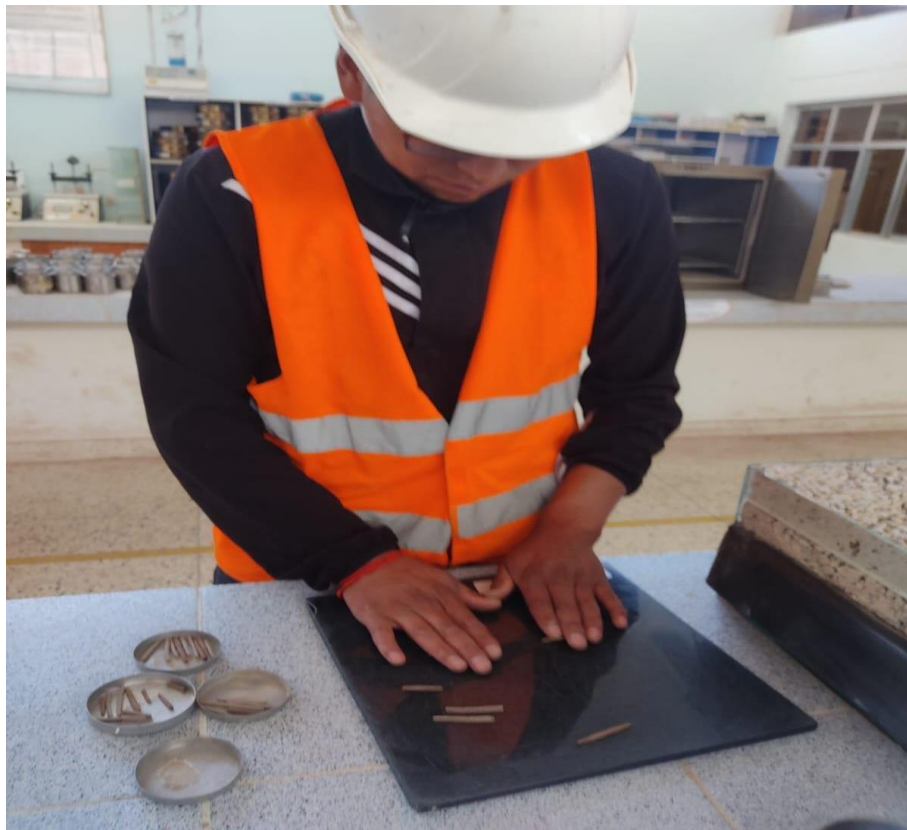
Fotografía 12. Ensayo de limite Plástico
