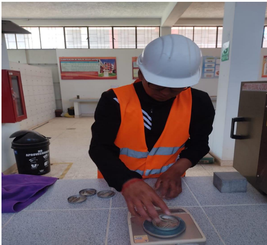
Fotografía 14. Pesaje de la muestra de límites paso 2
