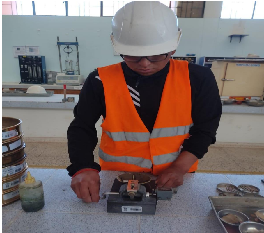
Fotografía 9. Ensayo de limite liquido paso 1
