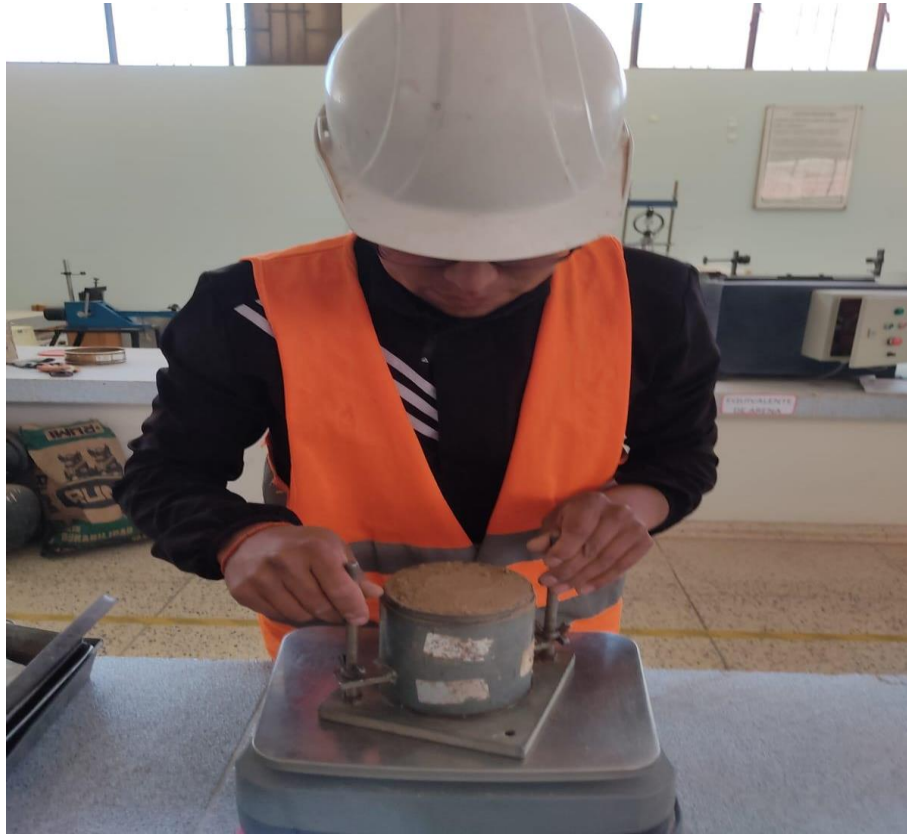
Fotografía 20. Prueba de compactación paso 5
