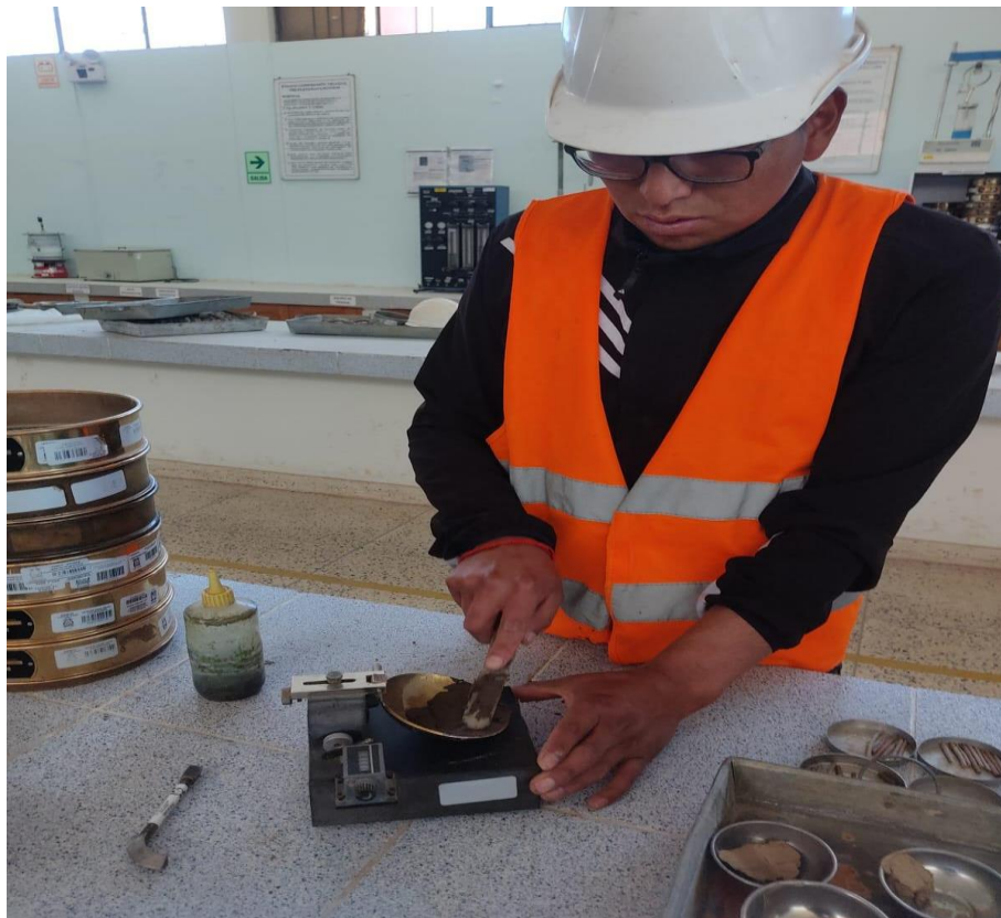
Fotografía 10. Ensayo de limite liquido paso 2
