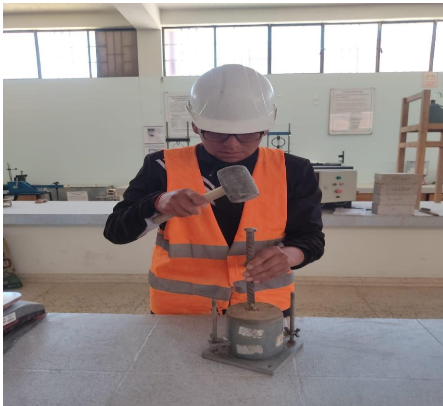
Fotografía 20. Prueba de compactación paso 5
