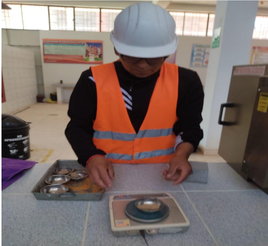
Fotografía 14. Pesaje de la muestra de límites paso 2
