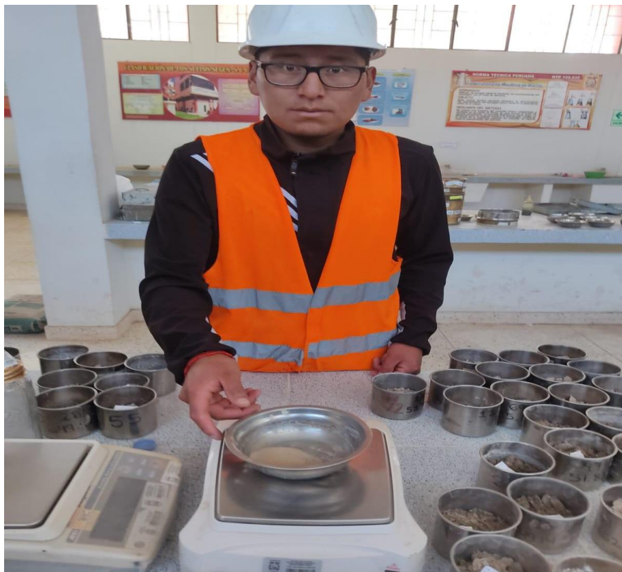
Fotografía 8. Pesaje de muestra para prueba de límites
