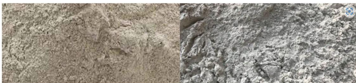
Cenizas volantes con alto contenido de calcio
