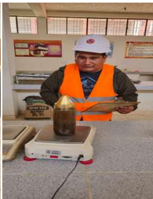
PANEL N° 7 – SATURAMOS LA MUESTRA DE LA GRAVA Y ARENA PARA EL ENSAYO DE ABSORCIÓN Y PESO ESPECÍFICO
