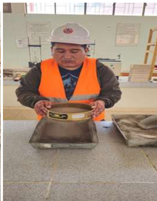
PANEL N° 8 – LA ZEOLITA PULVERIZADA LO TAMIZAMOS EN LA MALLA N° 200 PARA SU USO
