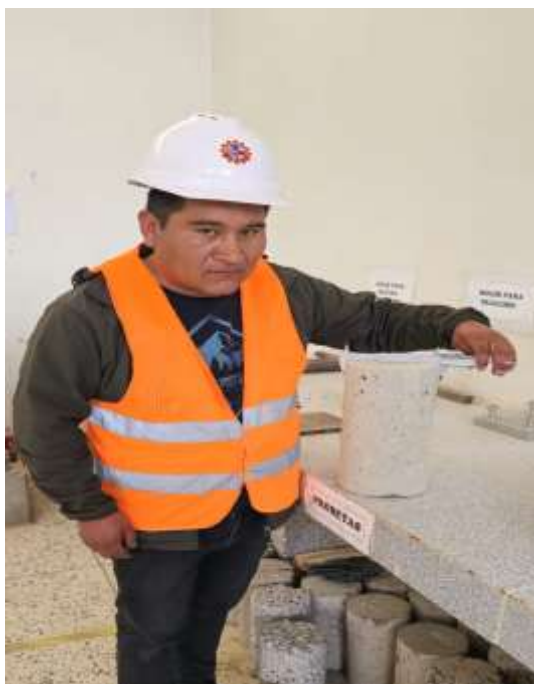
PANEL N° 9 – SACAMOS LAS PROBETAS DEL POZO DE CURADO Y LUEGO MEDIMOS SU DIAMETRO
