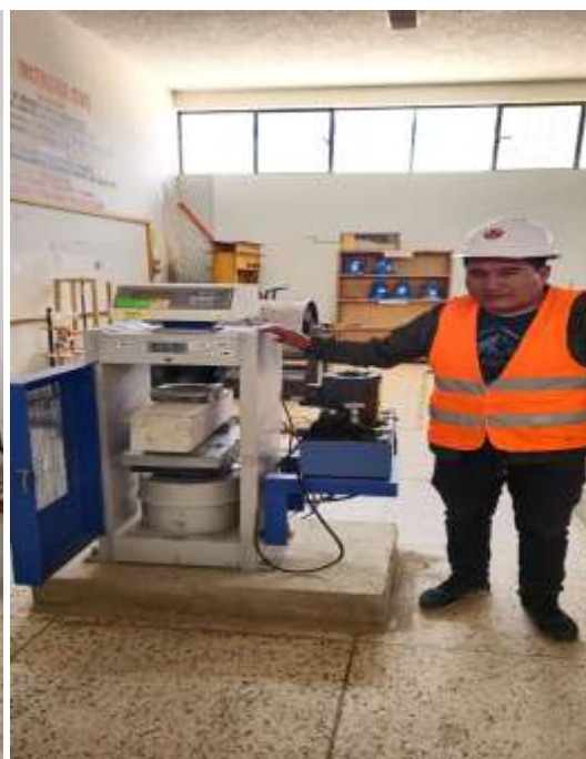
PANEL N° 10 – REALIZAMOS LAS PRUEBAS DE ROTURA DE LA PROBETA A COMPRESION Y LAS VIGAS PARA EL ENSAYO A FLEXIÓN
