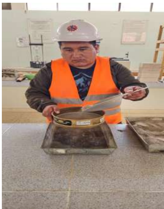
PANEL N° 8 – LA ZEOLITA PULVERIZADA LO TAMIZAMOS EN LA MALLA N° 200 PARA SU USO
