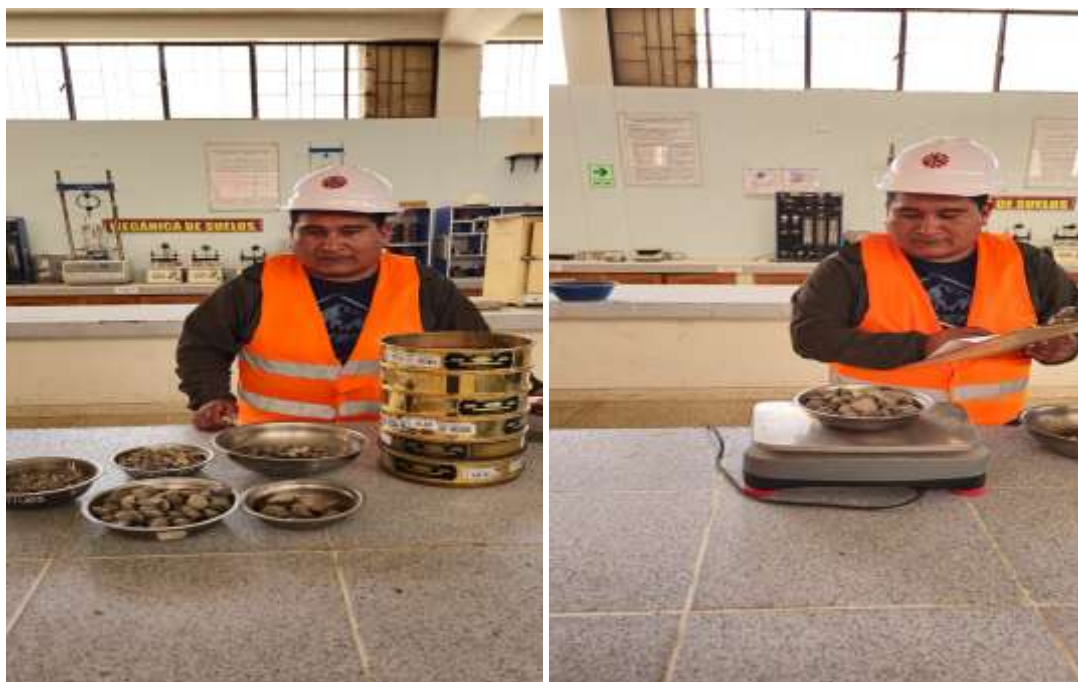
PANEL N° 2 - ENSAYO GRANULOMETRICO DE LA GRAVA
