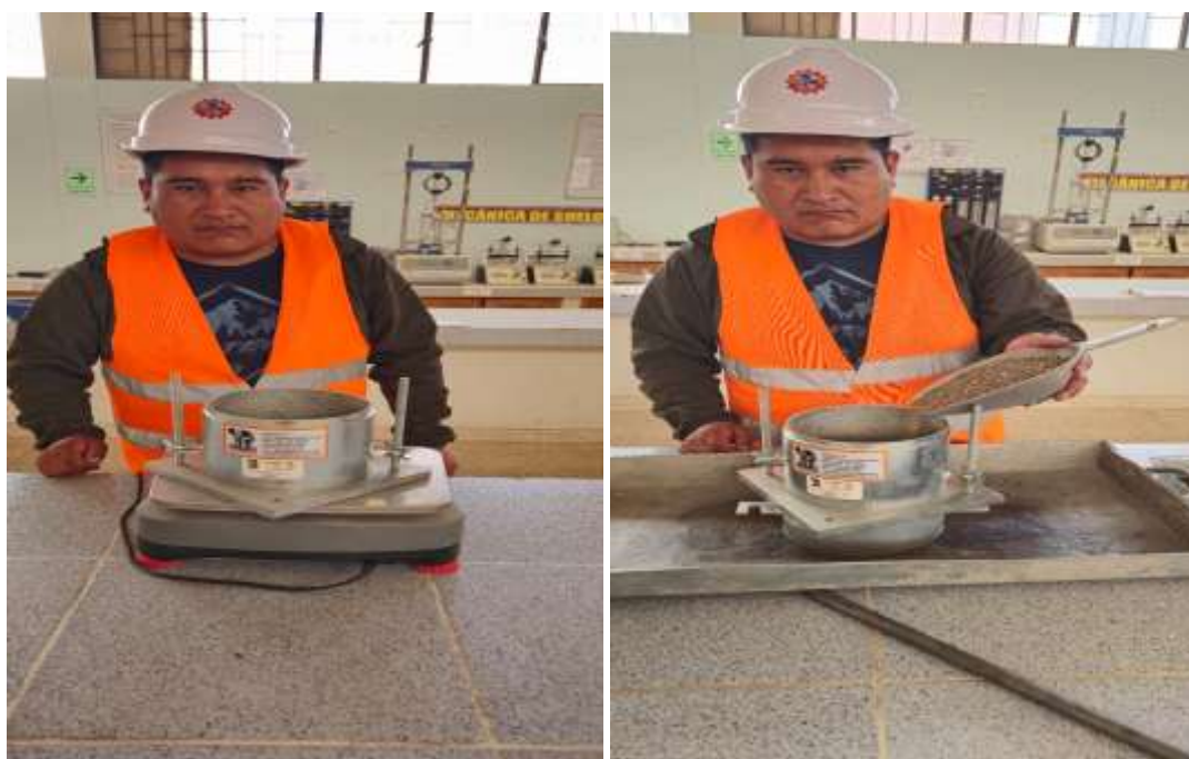
PANEL N° 4 - ENSAYO A CAIDA LIBRE DE PESOS UNITARIO DE LA ARENA
