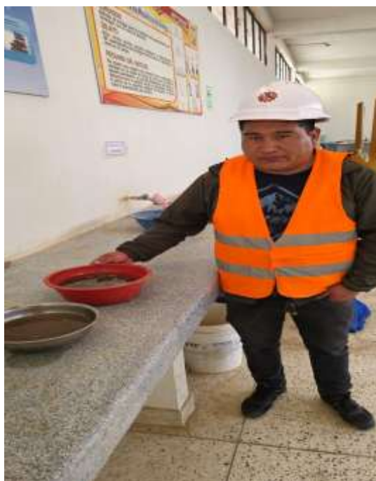
PANEL N° 7 – SATURAMOS LA MUESTRA DE LA GRAVA Y ARENA PARA EL ENSAYO DE ABSORCIÓN Y PESO ESPECÍFICO
