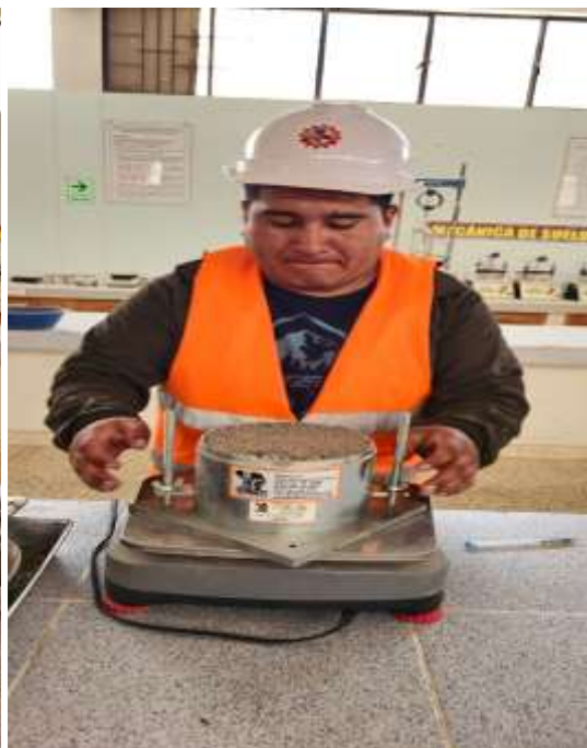
PANEL N° 5 - ENSAYO VARILLADO DE PESOS UNITARIOS DE LA ARENA
