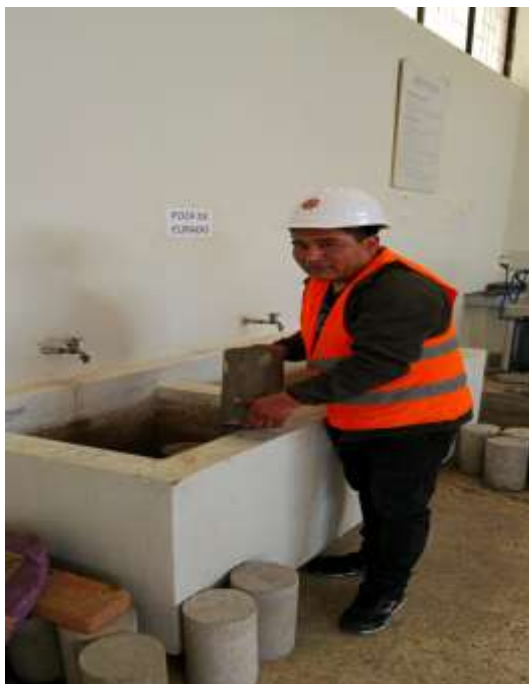
PANEL N° 9 – SACAMOS LAS PROBETAS DEL POZO DE CURADO Y LUEGO MEDIMOS SU DIAMETRO
