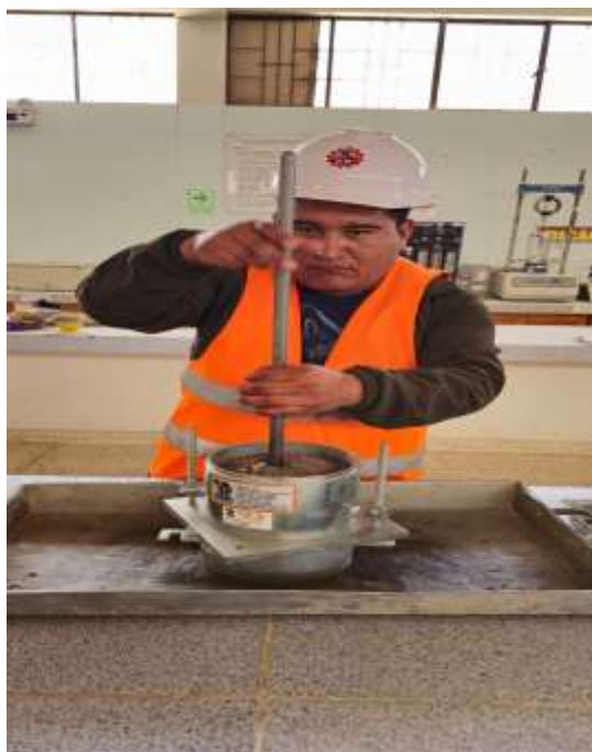
PANEL N° 5 - ENSAYO VARILLADO DE PESOS UNITARIOS DE LA ARENA
