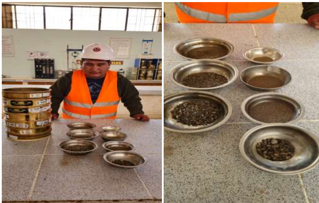
PANEL N° 3 - ENSAYO GRANULOMETRICO DE LA ARENA
