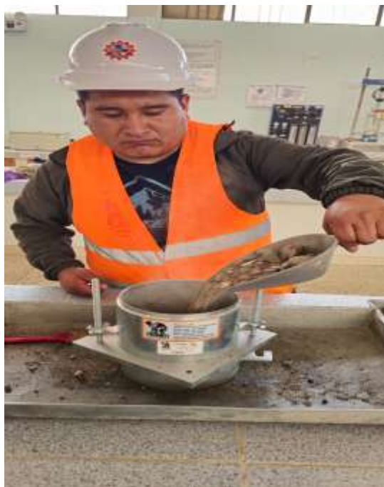
PANEL N° 6 - ENSAYO A CAIDA LIBRE Y VARILLADO DEL PESO UNITARIO DE LA GRAVA
