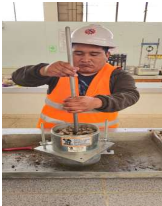
PANEL N° 6 - ENSAYO A CAIDA LIBRE Y VARILLADO DEL PESO UNITARIO DE LA GRAVA
