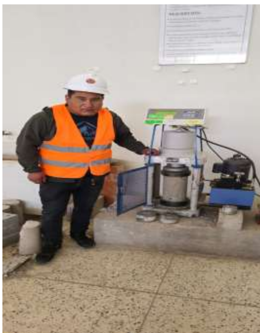
PANEL N° 10 – REALIZAMOS LAS PRUEBAS DE ROTURA DE LA PROBETA A COMPRESION Y LAS VIGAS PARA EL ENSAYO A FLEXIÓN
