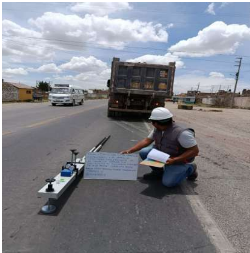
Fotografía 2. Evaluación con la Viga Benkelman
