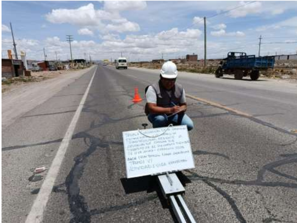
Fotografía 3. Evaluación con la Viga Benkelman en el 1323+050
