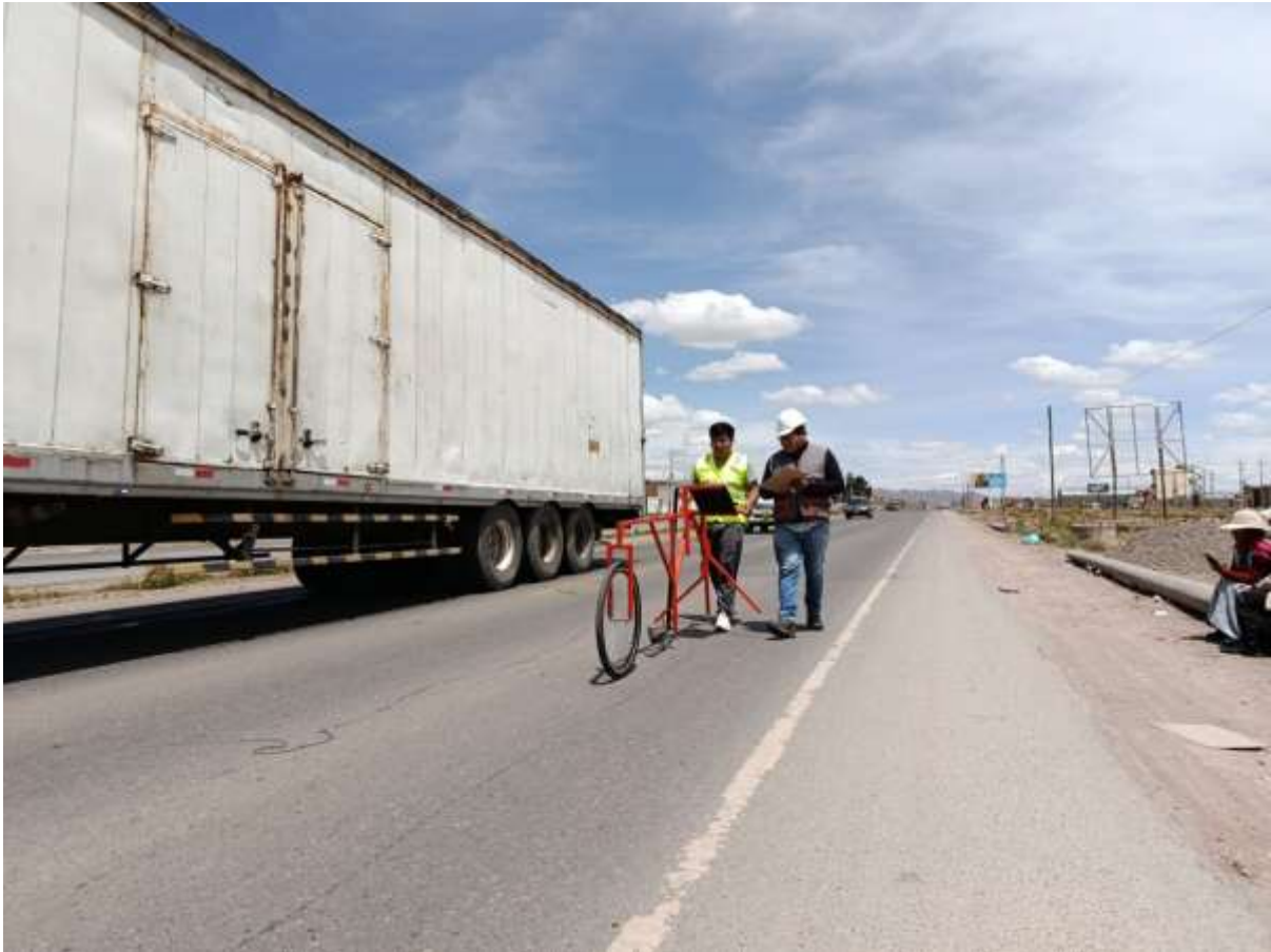
Fotografía 5. Evaluación con el rugosímetro de Merlín en el carril derecho
