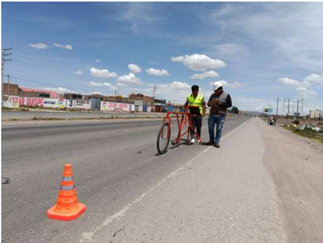
Fotografía 4. Evaluación con el rugosímetro de Merlín en el carril derecho
