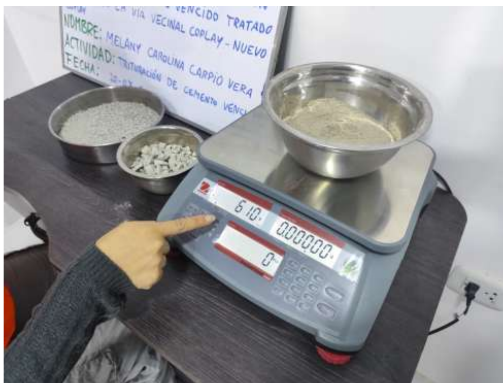
Fotografía 5. Pesaje de cemento vencido para su adición.
