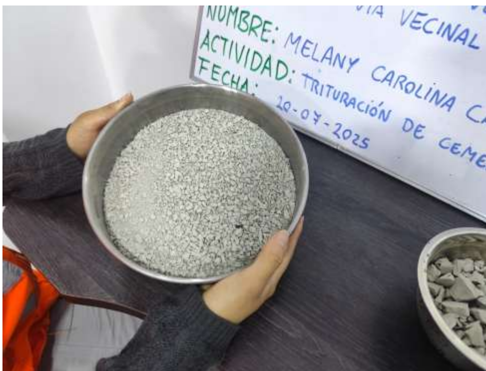
Fotografía 2. Cemento vencido triturado en gradación pasante la malla N° 4.
