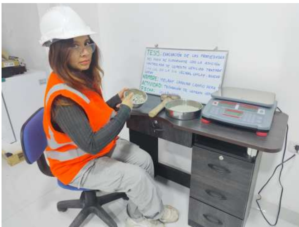
Fotografía 1. Trituración del cemento vencido.
