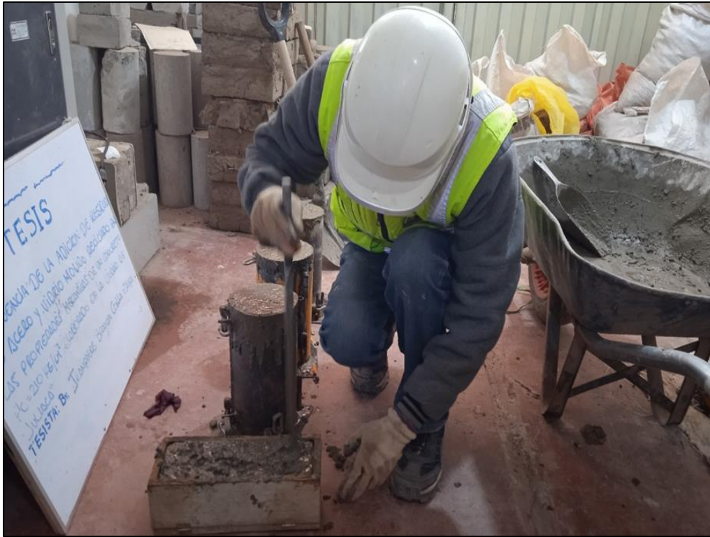
Fotografía 012. Ensayo del ensayo de Slump
