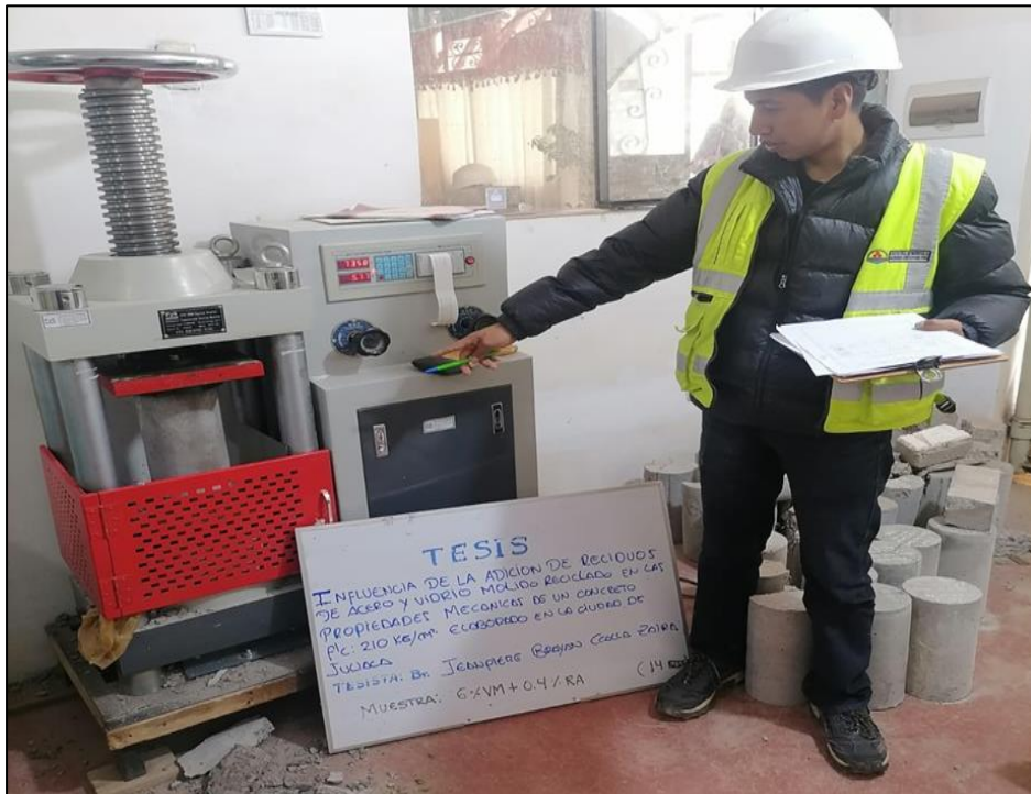
Fotografía 016. Rotura de briquetas con adición de 6 % VMR + 0.4% RA ensayo a flexion.
