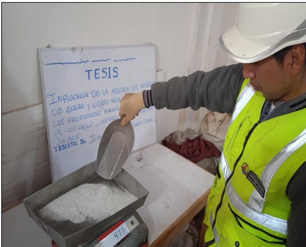
Fotografía 010. Peso del vidrio molido reciclado para la adición al cemento
