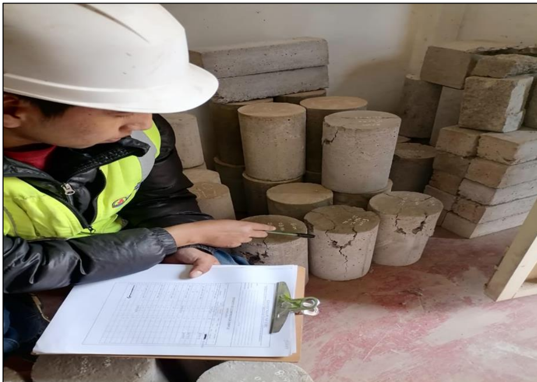
Fotografía 018. Se observa las fallas por rotura máxima.
