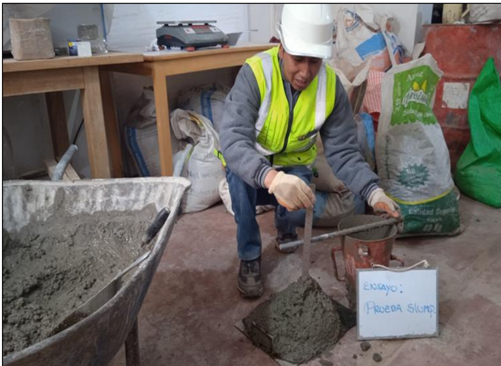
Fotografía 012. Ensayo del ensayo de Slump
