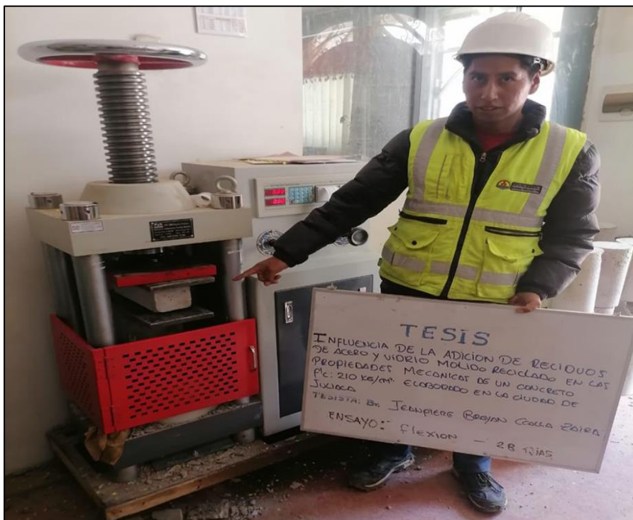
Fotografía 016. Rotura de briquetas con adición de 6 % VMR + 0.4% RA ensayo a flexion.
