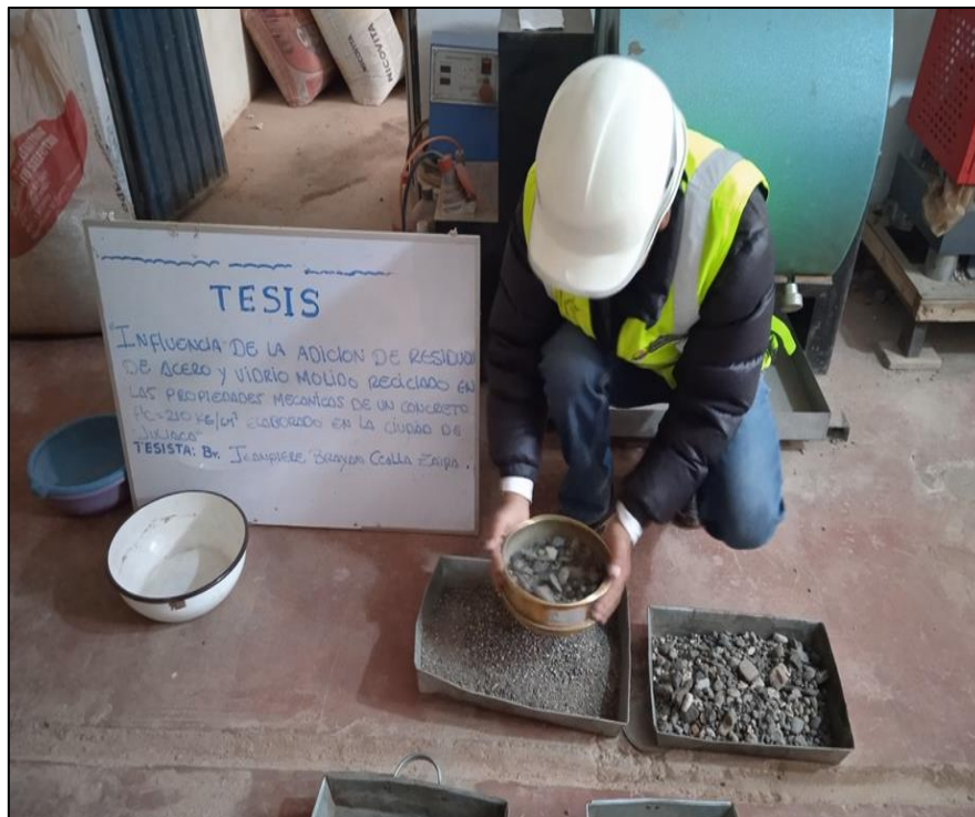
Fotografía 04. Realizado del ensayo de granulometría de los agregados natural.
