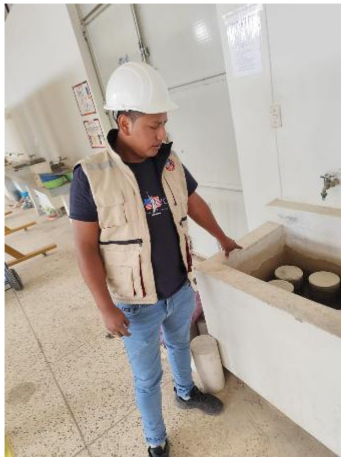
Fotografía 6. Curado de briquetas
