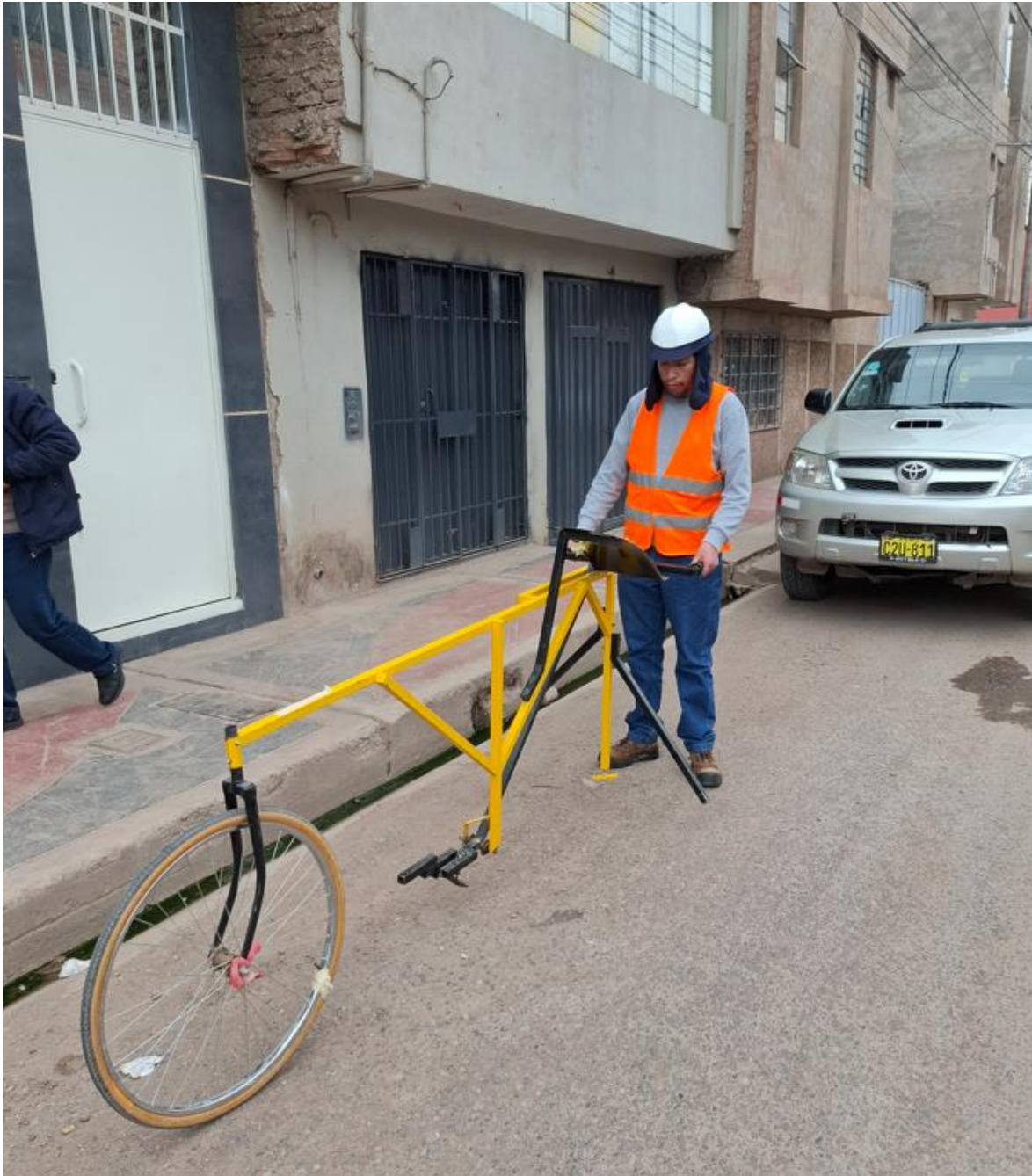
Fotografía 01 – IRI PROG 0+000 AL 0+200 MARGEN DERECHO
