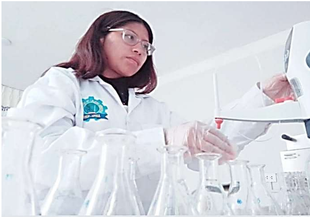
Figura 34 Proceso final del análisis de la DQO titulando
