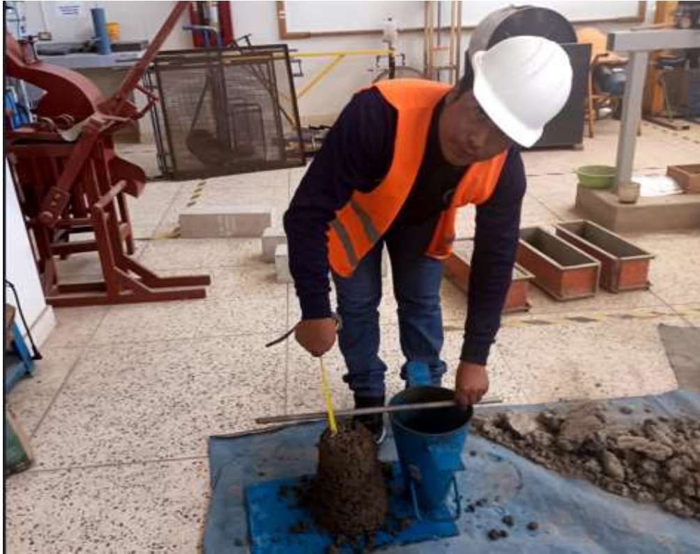
Fotografía 5. Ensayo de asentamiento
