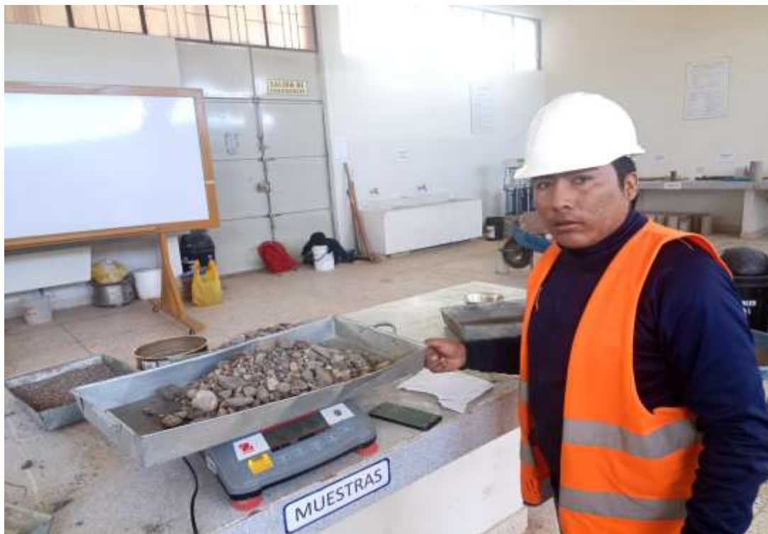
Fotografía 2. Pesado del agregado grueso
