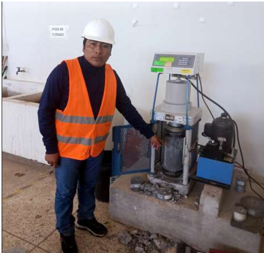
Fotografía 6. Ensayo de resistencia a la compresión
