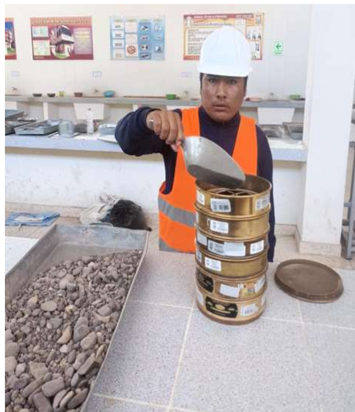
Fotografía 4. Ensayo de granulometría
