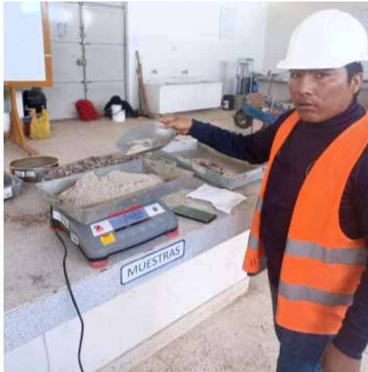
Fotografía 3. Pesado del agregado fino
