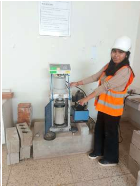
Fotografía 6. Rotura de briquetas
