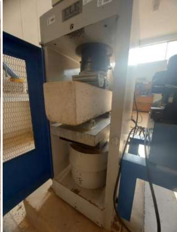
Fotografía 7. Rotura de vigas
