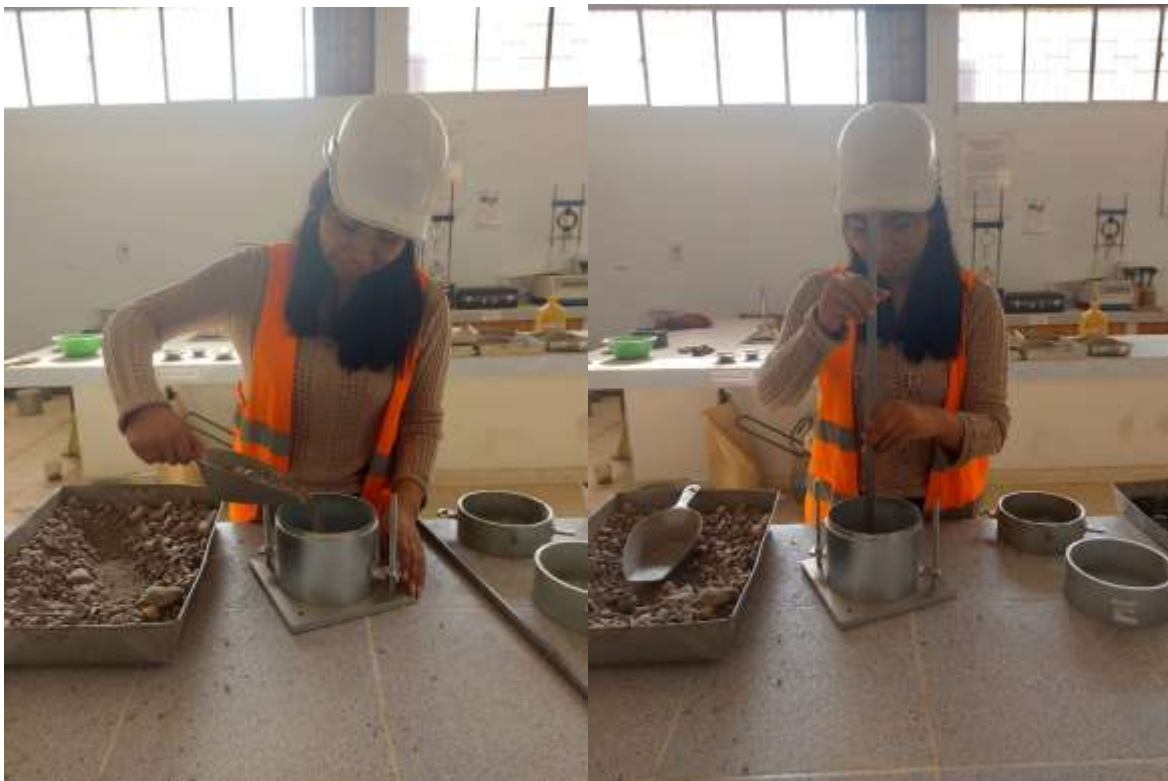
Fotografía 4. Peso unitario suelto y varillado del agregado
