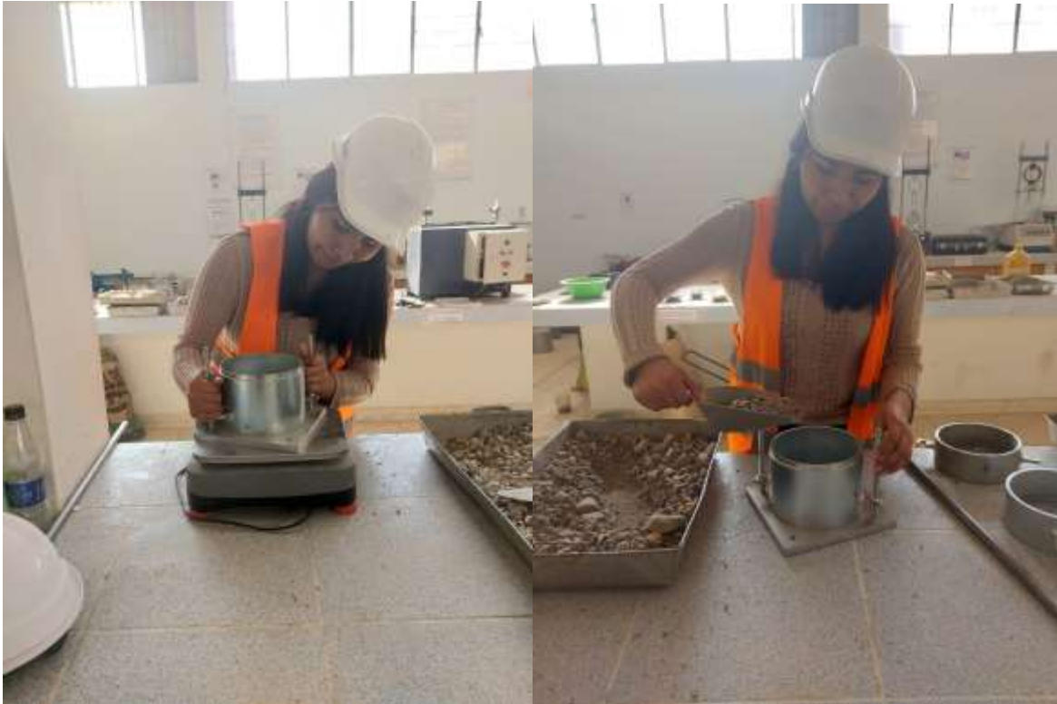
Fotografía 3. Peso unitario suelto y varillado del agregado
