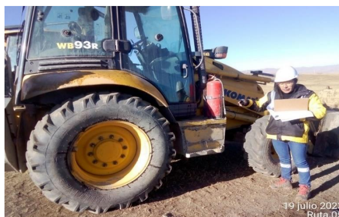
Nota. Inspección de extintor en retroexcavadora.
