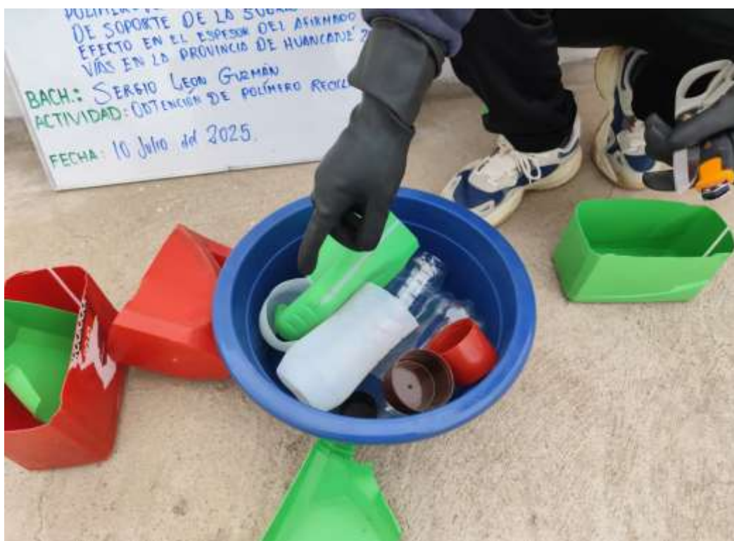
Fotografía 2. Limpieza y preparación de los plásticos
