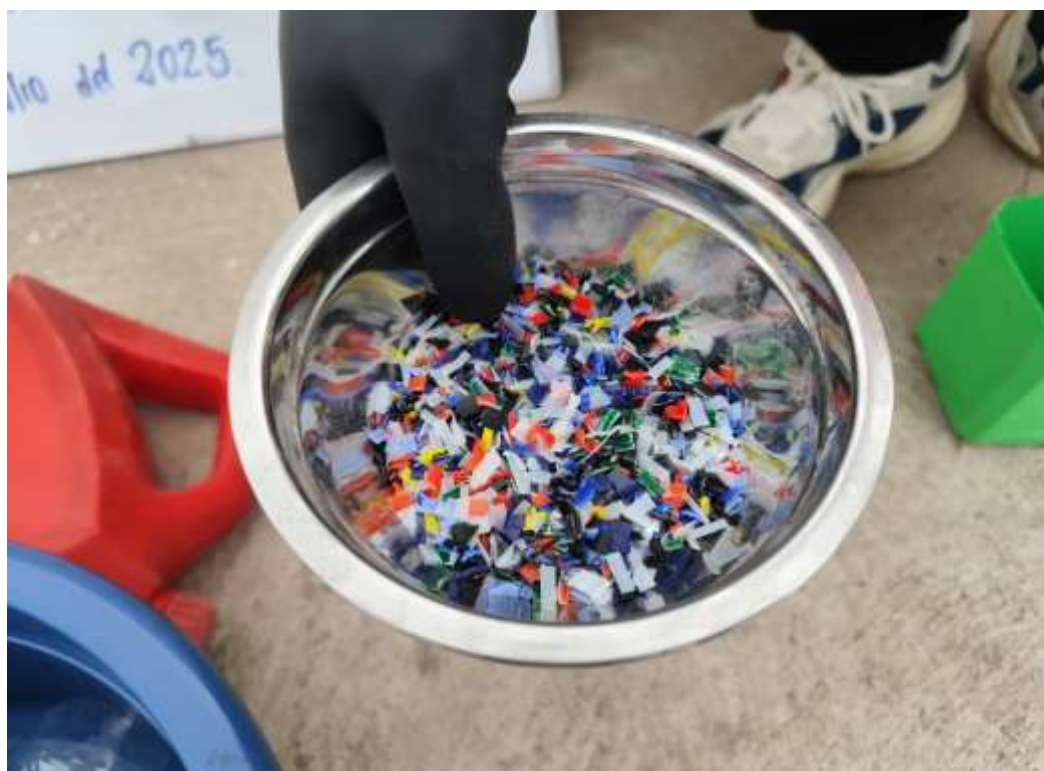
Fotografía 4. Polímeros (plásticos reciclados) en cortes pequeños de 5 mm x 2 mm.
