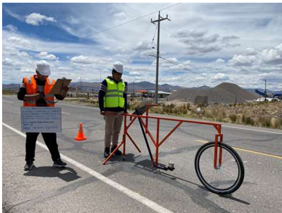
Fotografía 9. Evaluación del IRI en el tramo 17
