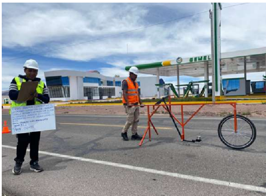
Fotografía 7. Evaluación del IRI en el tramo 11
