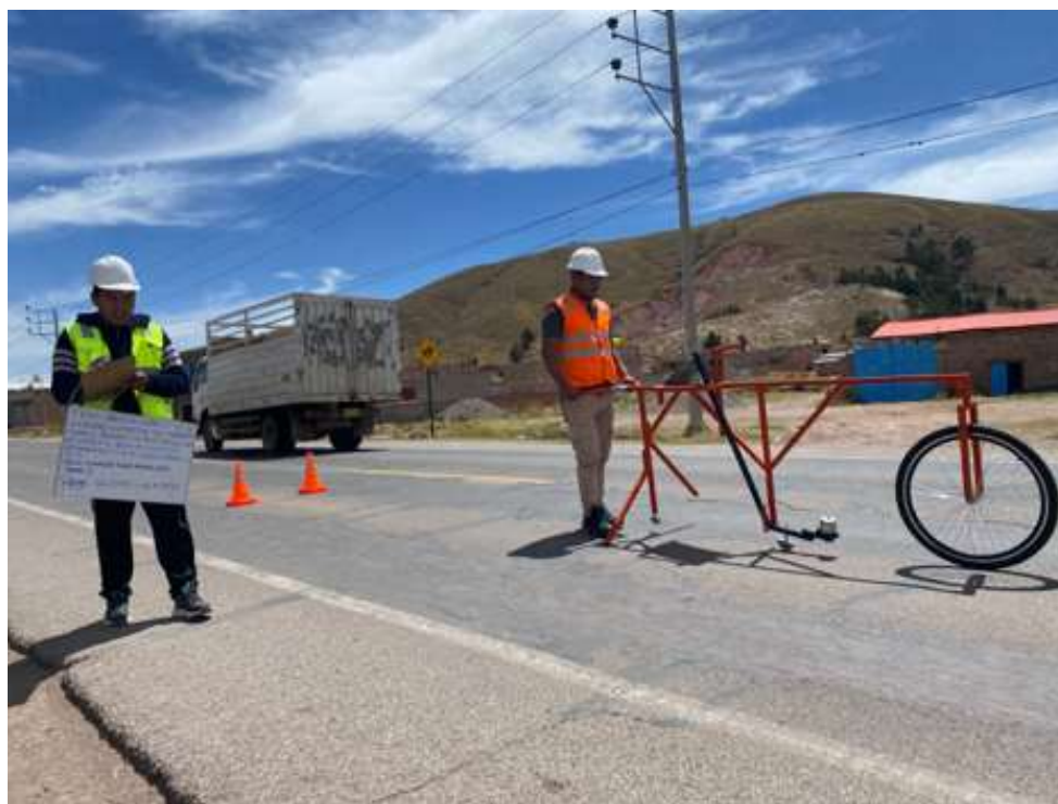
Fotografía 5. Evaluación del IRI en el tramo 8
