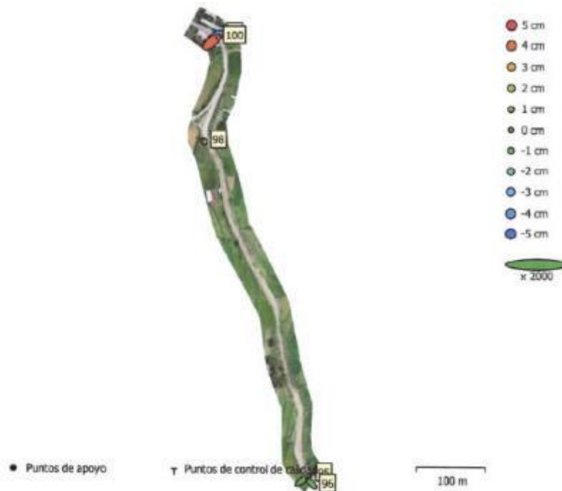
Fig. 3. Posiciones de puntos de apoyo y estimaciones de errores. El color indica el error en Z mientras el tamaño y forma de la elipse representan el error en XY. Las posiciones estimadas de puntos de apoyo se marcan con puntos o cruces.
