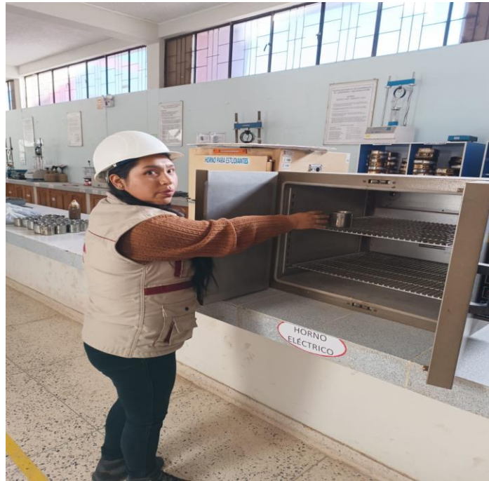
Fotografía 05. Secado de las muestras al horno
