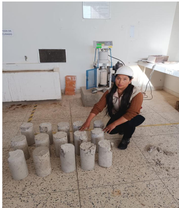
Fotografía 04. Briquetas sometidas a compresión
