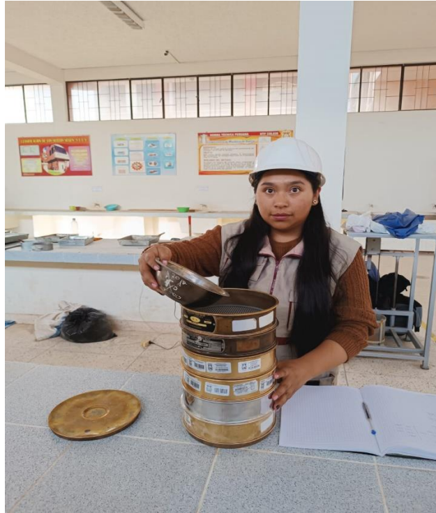
Fotografía 07. Tamizado de los agregados
