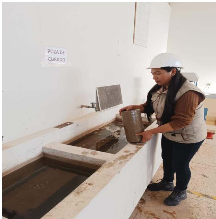
Fotografía 02. Curado de briquetas
