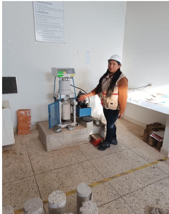
Fotografía 08. Ensayo de resistencia a la compresión
