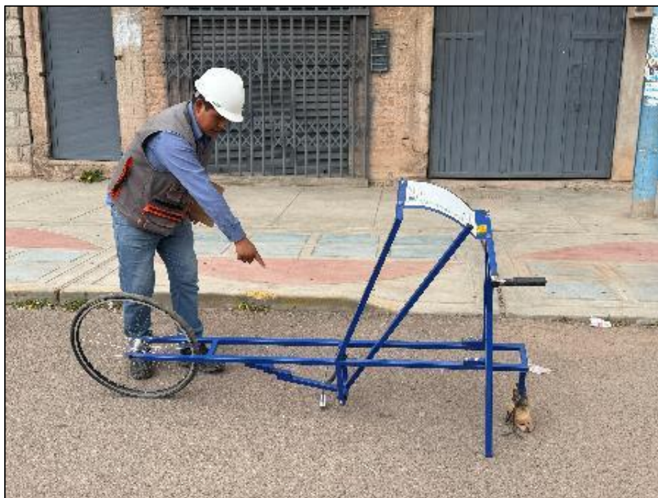
Fotografía 1. Equipo de rugosímetro de Merlín.
