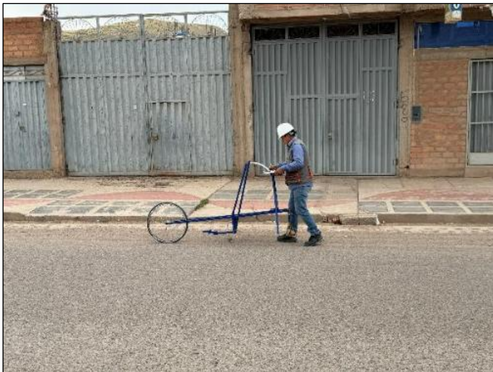
Fotografía 7. Aplicación del equipo de rugosímetro de Merlín en un recorrido.
