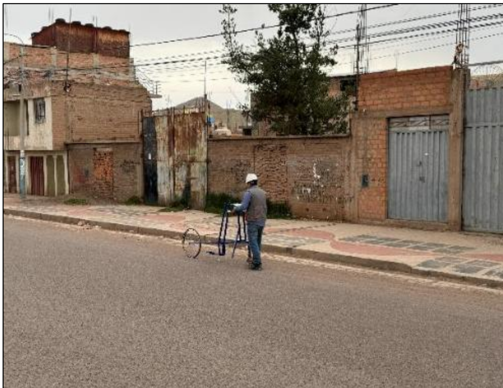
Fotografía 5. Recorrido con el equipo Merlín del tramo de la sección de la calzada.
