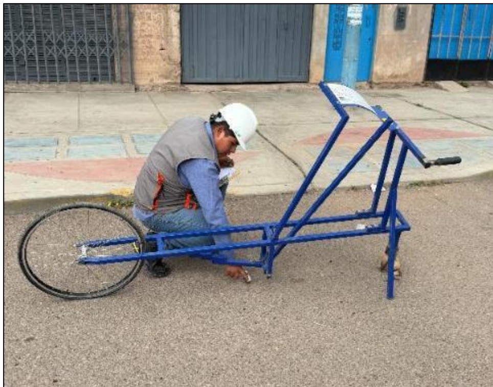
Fotografía 21. Desviaciones verticales en un carril de la calzada 2.
