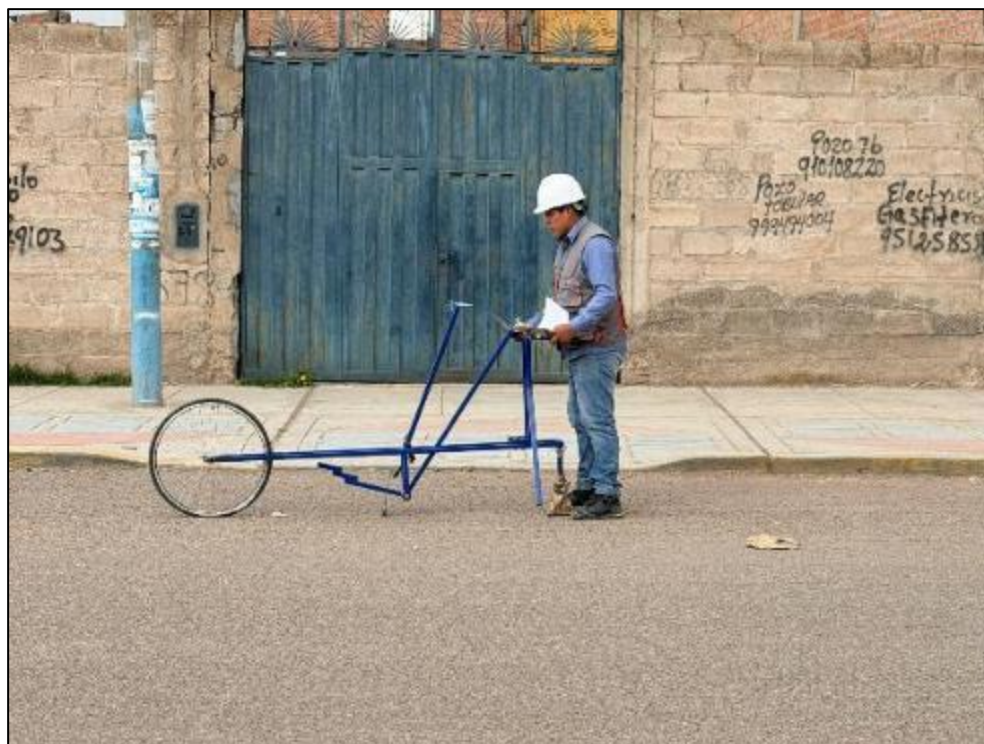
Fotografía 15. Verificación del equipo de rugosímetro de Merlín.
