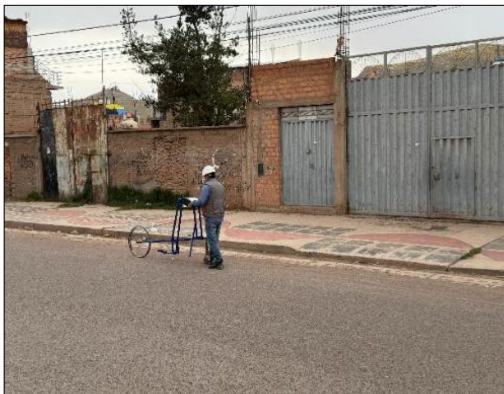
Fotografía 6. Sucesión del recorrido aplicando el equipo de Merlín.
