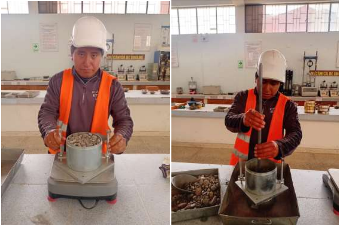
Fotografía 3. Peso unitario suelto y varillado del agregado
