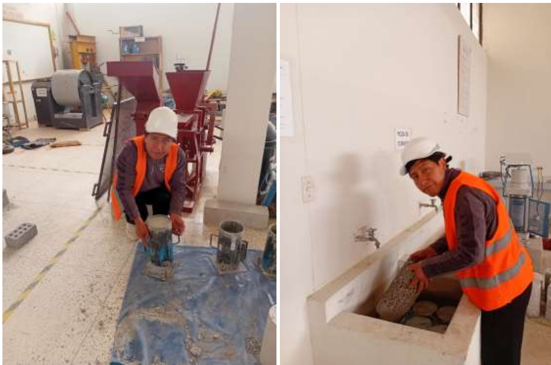
Fotografía 4. Desmoldeado y curado
