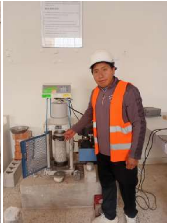
Fotografía 6. Medición y rotura de briquetas
