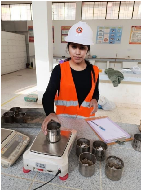
PESAMOS LAS MUESTRAS HUMEDA PARA LLEVARLAS AL HORNO
