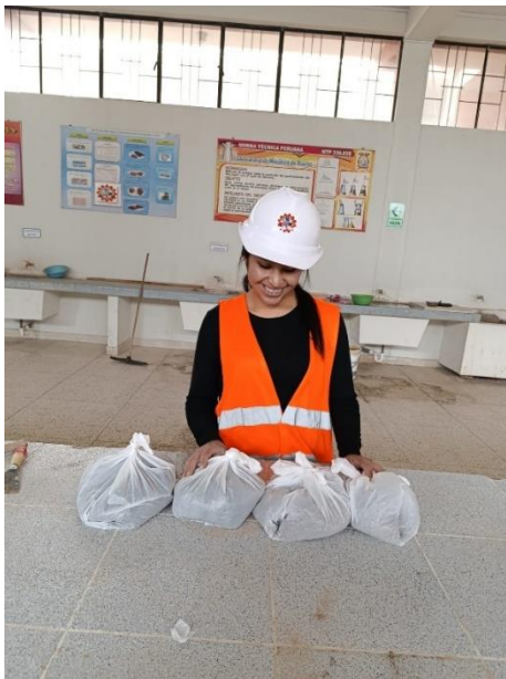
PONEMOS LAS MUESTRAS EN BOLSAS PARA HOMOGENIZAR LA HUMEDAD
