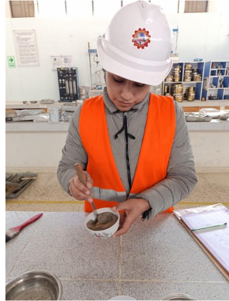
HOMEGENIZAMOS LA MEZCLA PARA REALIZAR LOS LIMTES DE CONSISTENCIA
