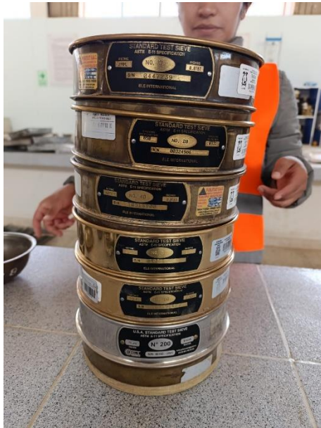
USAMOS LOS TAMICES DE MALLAS PARA SUELO FINO
