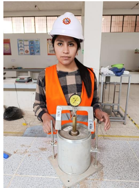
COLOCAMOS EL DIAL DE NUESTRO CBR PARA LA SATURACIÓN POR 4 DIAS
