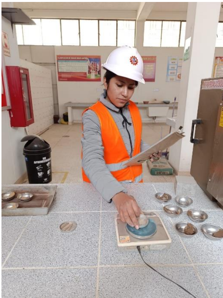
PESAMOS LAS MUESTRAS DEL LIMITE PLASTICO
