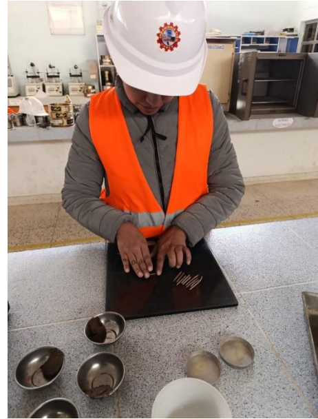
REALIZAMOS LOS ROLLITOS DEL LIMITE PLASTICO
