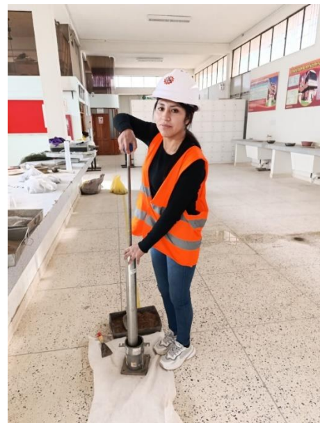
REALIZAMOS LOS GOLPES CON EL PISTON PARA PROCTOR MODIFICADO
