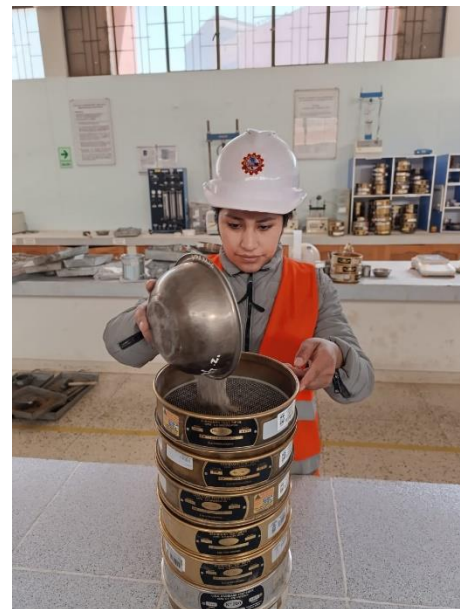
TAMIZAJE DE LA CENIZA DE EUCALIPTO
