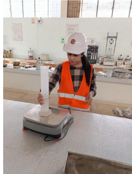
PESAMOS EL AGUA PARA HUMEDECER LAS MUESTRAS EN DIFERENTES PORCENTAJES
