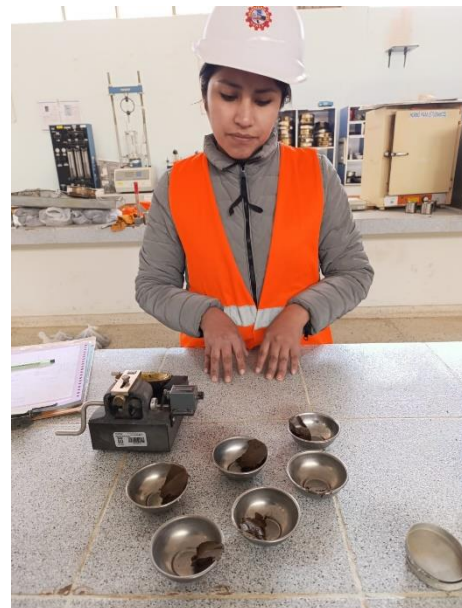
MUESTRAS DE LIMITE LIQUIDO CON DIFERENTES GOLPES
