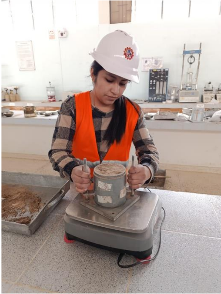
PESAMOS NUESTRO MOLDE PROCTOR MAS LA MUESTRA
