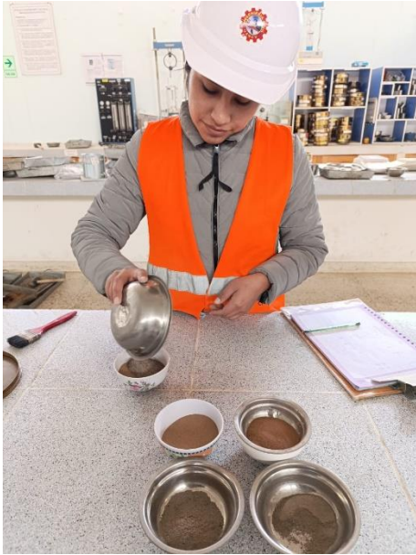
COMBINACIÓN DE CENIZAS DE EUCALIPTO CON MUESTRA NATURAL
