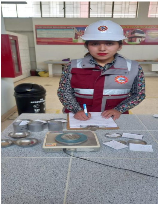
4. Registramos el peso de las taras y colocamos al horno para su secado
