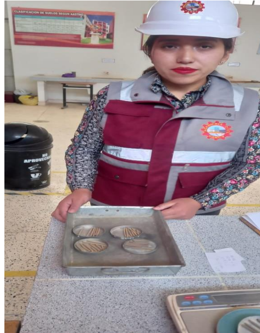
3. Hacemos los rollitos para el límite plástico y ponemos en las taras
