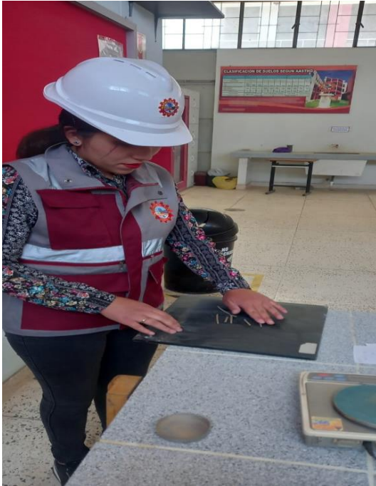
3. Hacemos los rollitos para el límite plástico y ponemos en las taras
