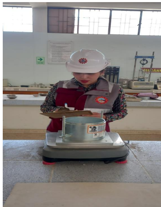
6. Pesamos la muestra y el molde para el ensayo proctor
