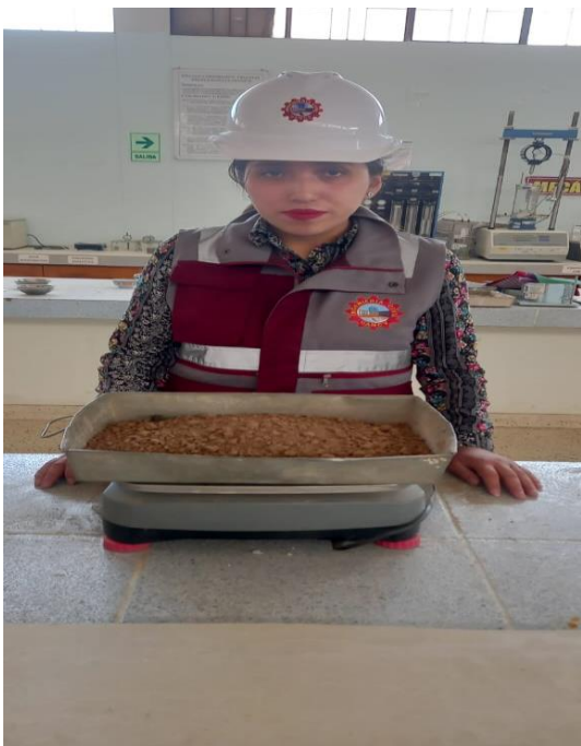
6. Pesamos la muestra y el molde para el ensayo proctor
