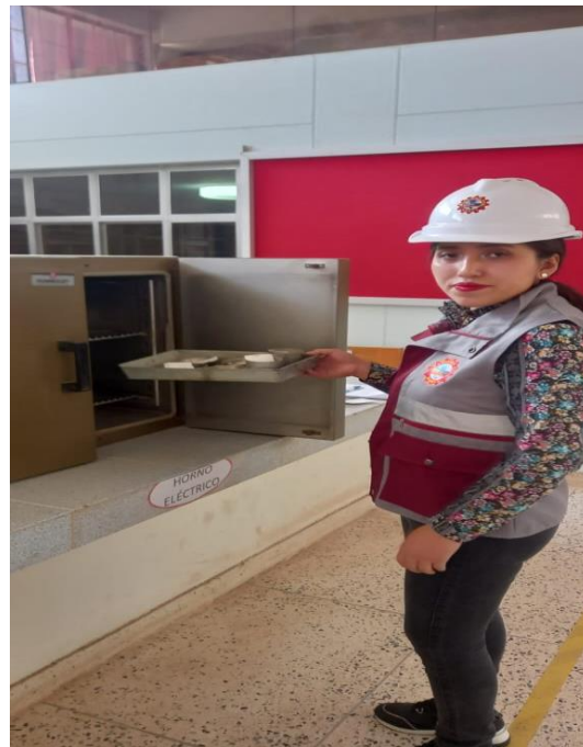
4. Registramos el peso de las taras y colocamos al horno para su secado
