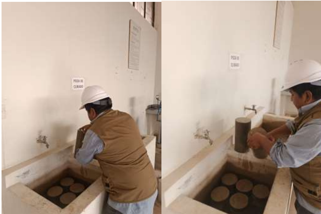
Fotografía 6. Curado del concreto
