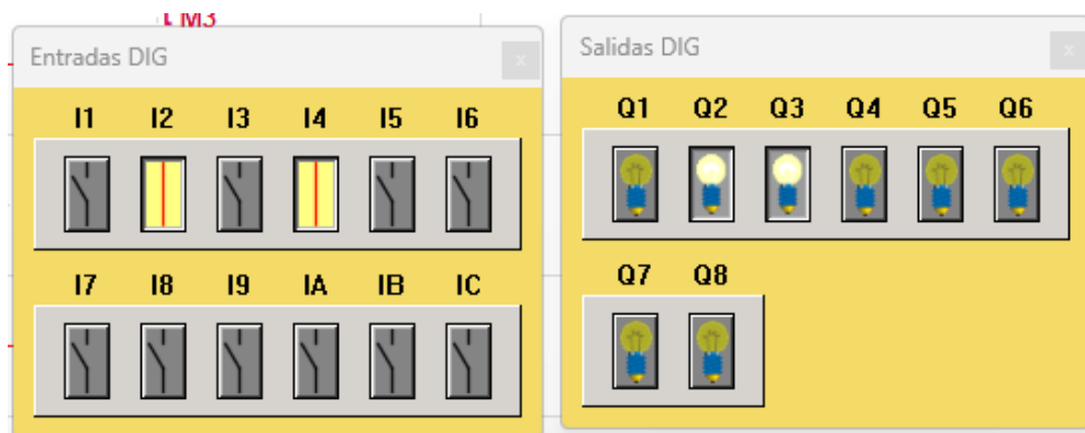
Entradas y salidas en Zelio PLC.
