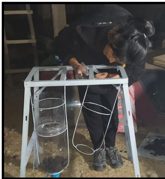
Nota. Construcción del prototipo de los filtros lentos de arena
