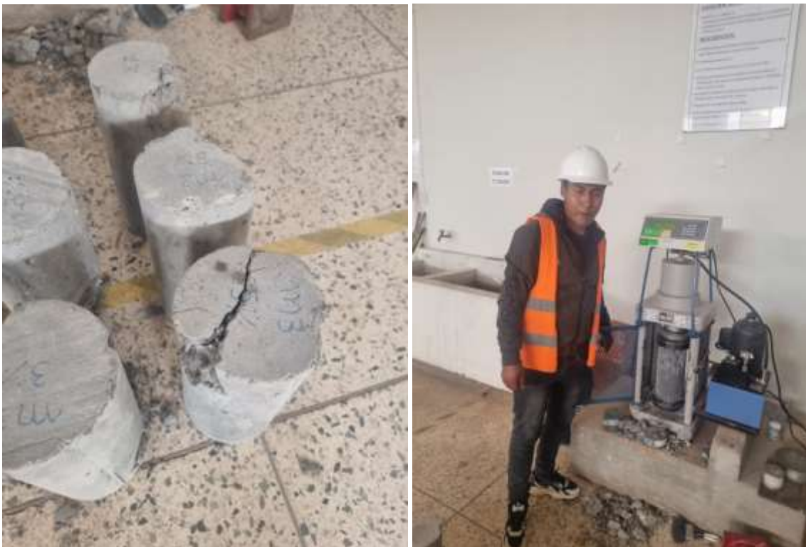
Fotografía 6. Rotura de briquetas
