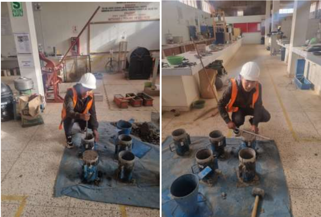
Fotografía 4. Vaciado de briquetas
