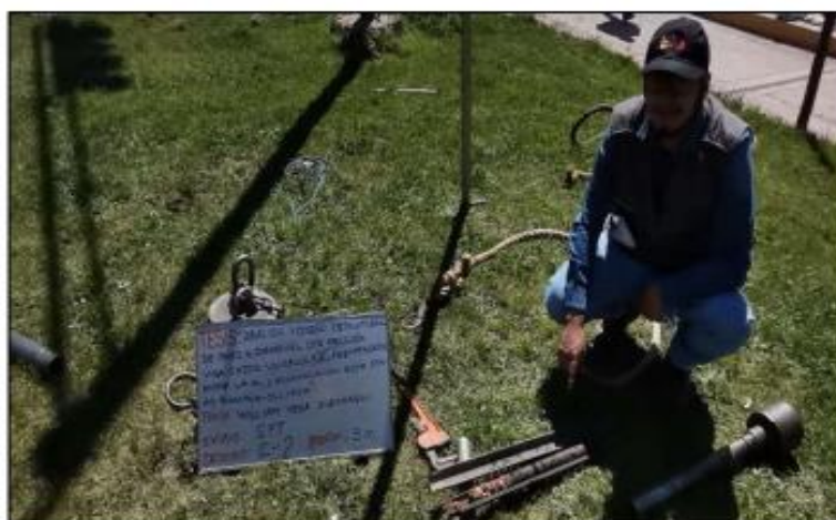
Extracción de muestra del suelo de C-2 en el eje de Pilar 01 y 02.
