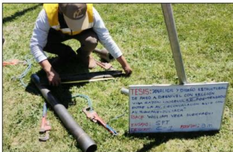
Extracción de muestra del suelo de calicata C-1 en el eje de Estribo Izquierdo
