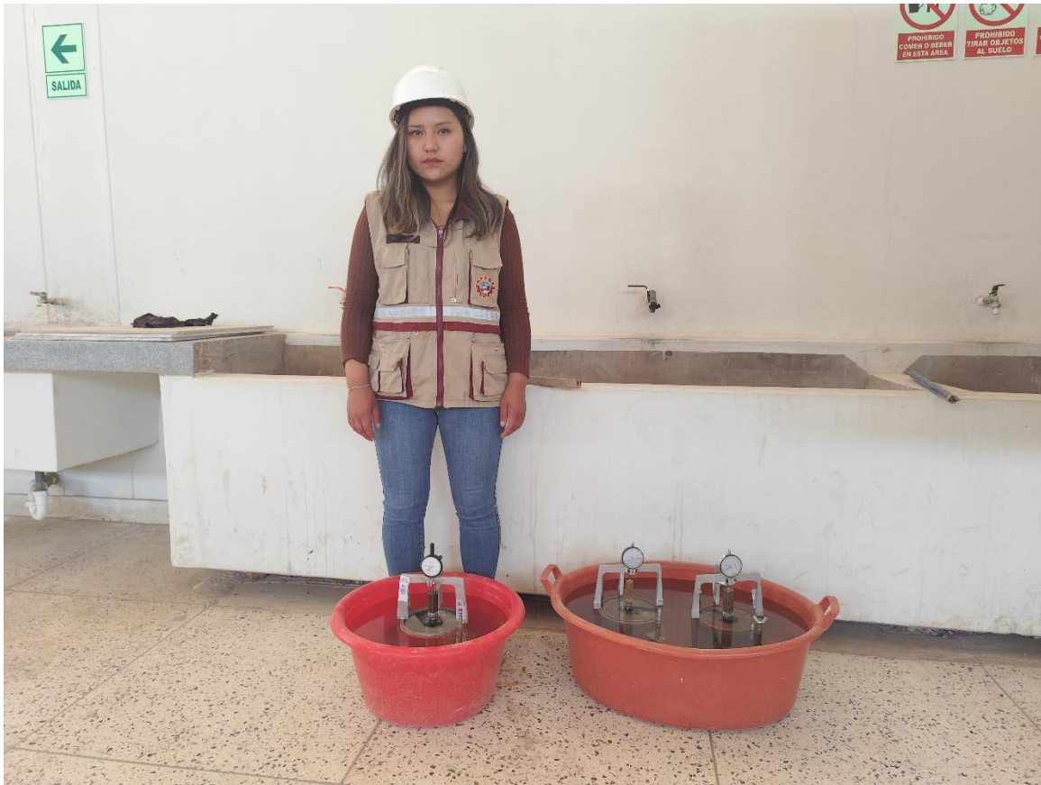
Fotografía 5. Ensayo Capacidad de Soporte.
