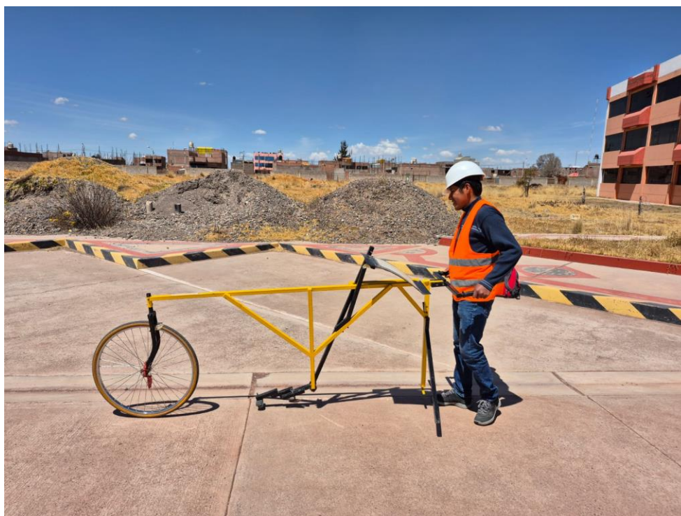
IMAGEN 002 – CALIBRACION EQUIPO RUGOSIMETRO MERLIN
