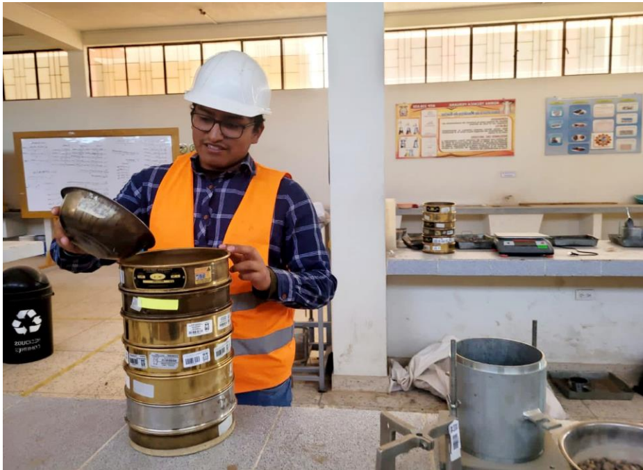
Fotografía 09. Tamizado de los agregados gruesos de la cantera de Isla
