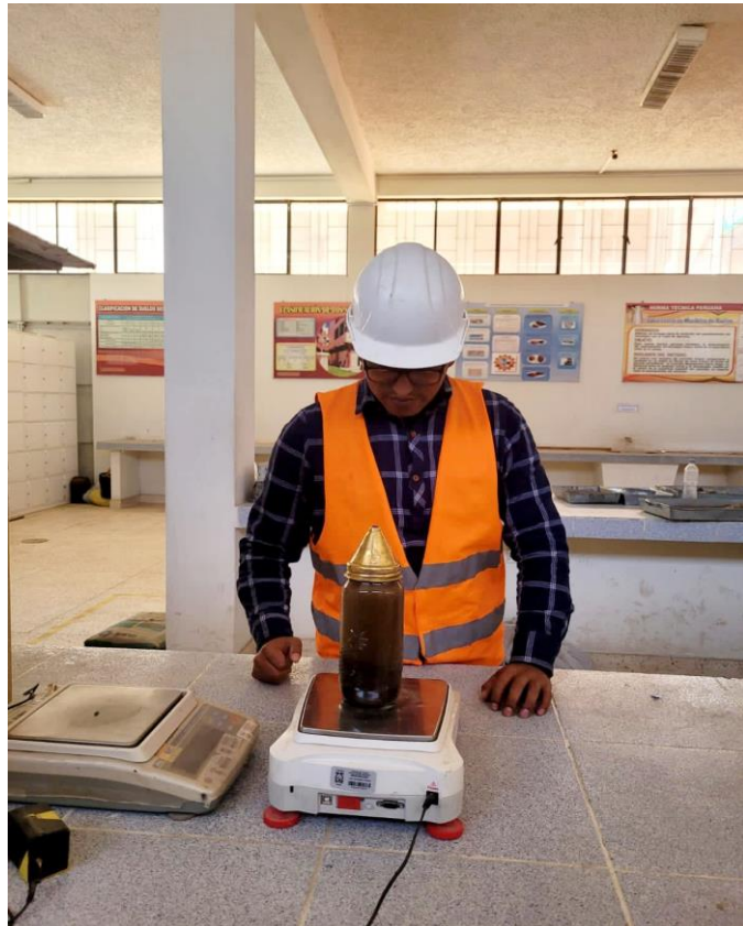
Fotografía 10. Ensayo de densidad de los agregados
