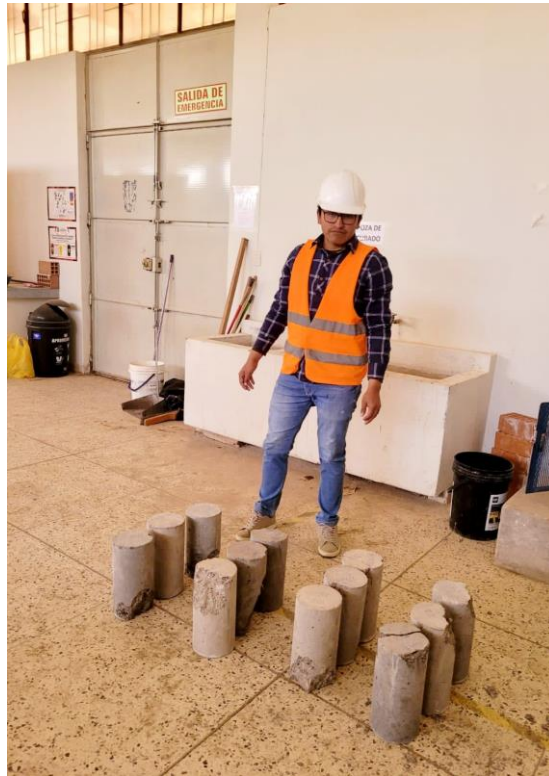
Fotografía 07. Testigos después de ser sometidos a compresión
