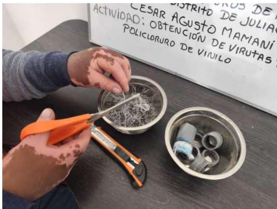
Fotografía 4. Remate de las virutas de policloruro de vinilo para que queden uniformes.
