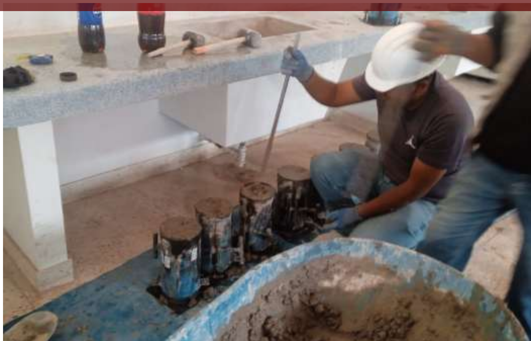
Fotografía 13. Colocación de mezcla en moldes de briquetas.
