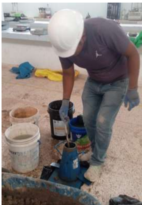
Fotografía 10. Colocación de mezcla al cono de Abrams
