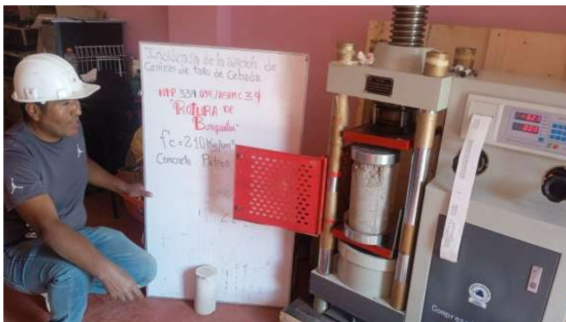
Fotografía 16. Rotura de briquetas
