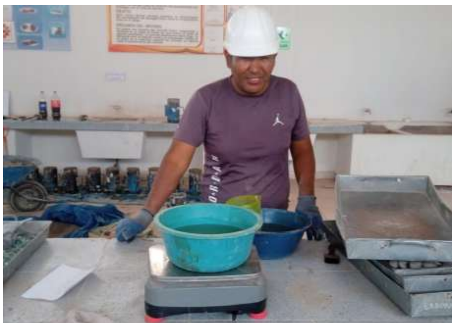
Fotografía 8. Pesaje del agua para la mezcla
