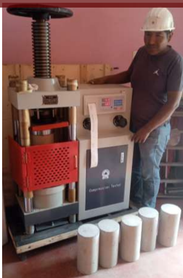
Fotografía 15. Aplicación de carga axial a briquetas
