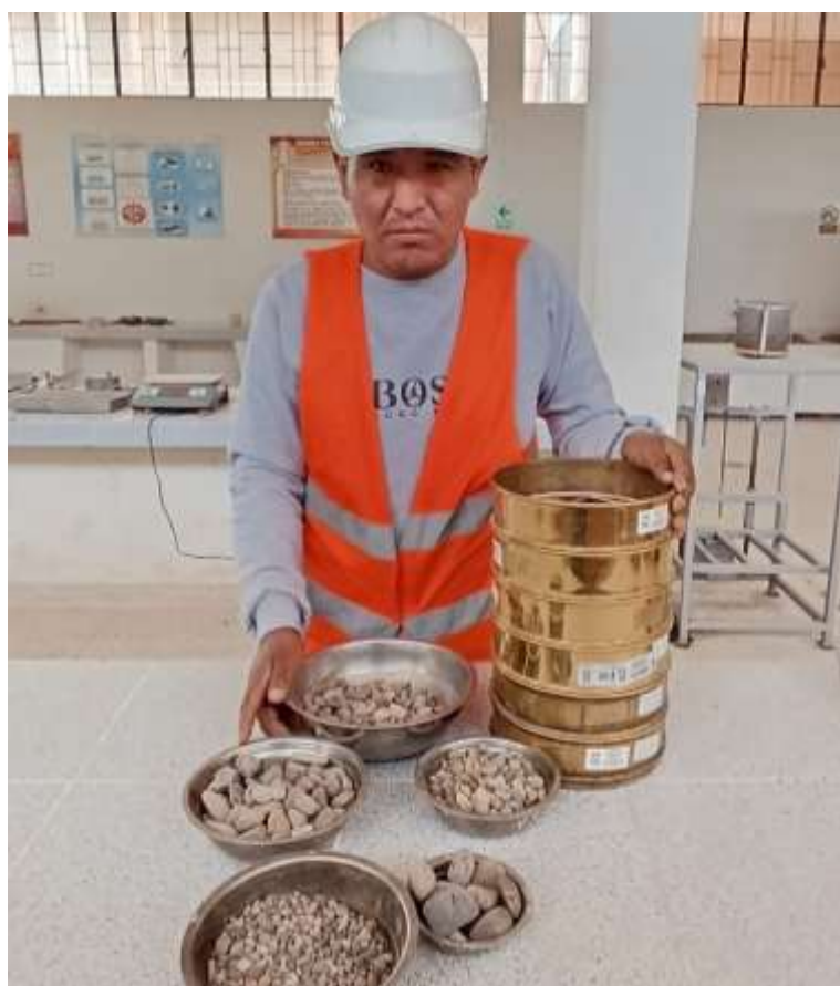
Fotografía 4. Análisis granulométrico del agregado grueso
