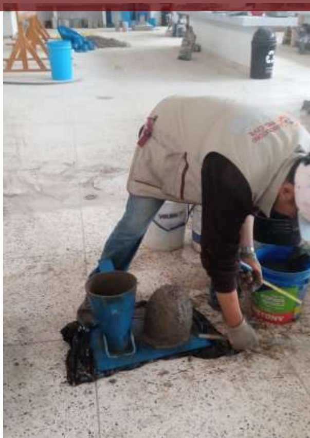
Fotografía 11. Quitado de molde de cono de Abrams
