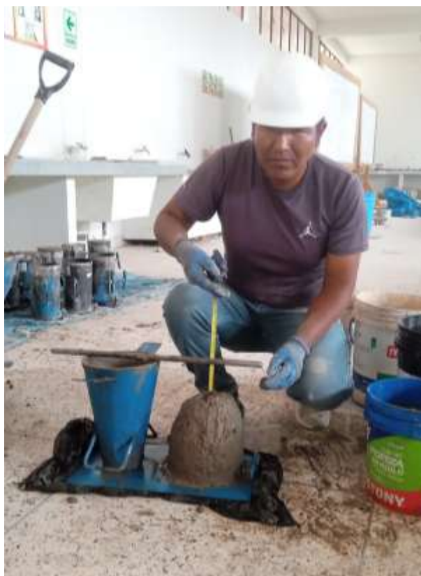
Fotografía 12. Medición del asentamiento
