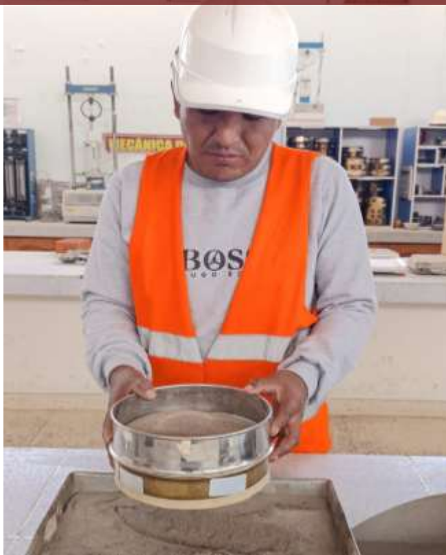
Fotografía 5. Análisis granulométrico del agregado fino
