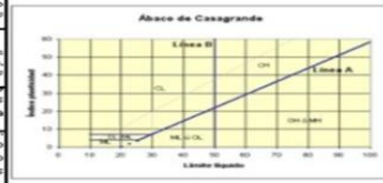
Figura 36. Sistema Unificado de Clasificación de Suelos Recuperado de Geotecnia – Unidad IV – Ing Dante Bosh
