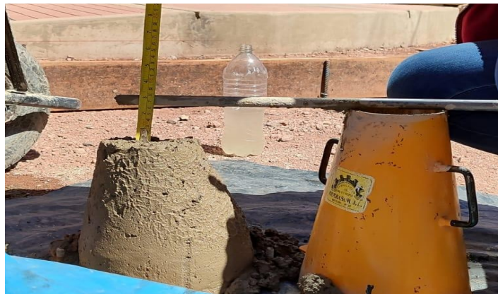
Nota. La figura muestra la prueba de SLUMP
