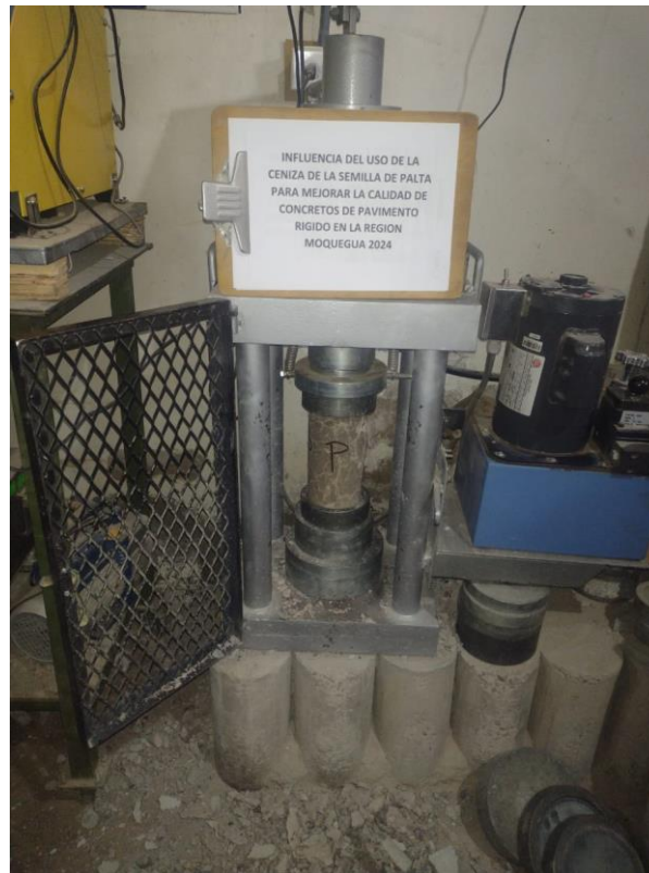
Fotografía N° 04: Rotura de probetas 4" x 8" a 28 días (muestra patrón)
