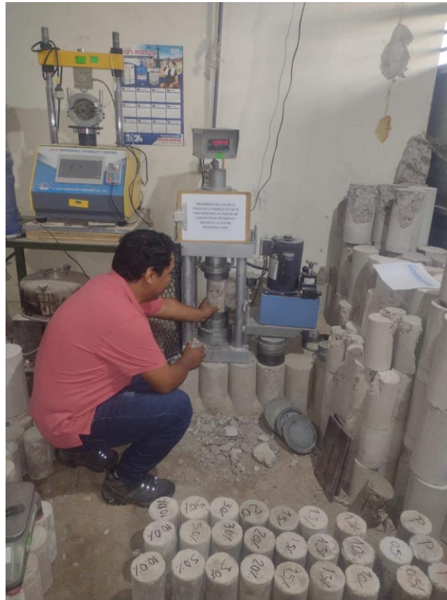
Fotografía N° 06: Rotura de probetas 4" x 8" a 14 días (1.3% de adición)
