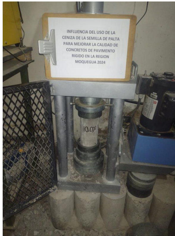
Fotografía N° 02: Rotura de probetas 4" x 8" a 28 días (10% de adición)
