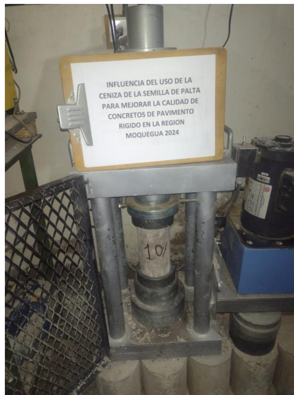
Fotografía N° 05: Rotura de probetas 4" x 8" a 28 días (1.0% de adición)
