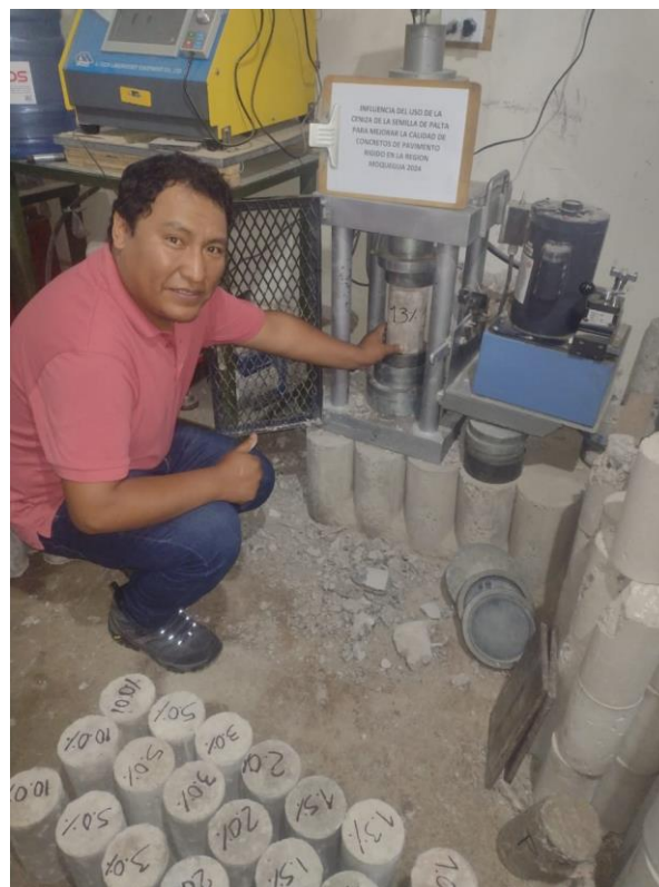
Fotografía N° 03: Rotura de probetas 4" x 8" a 28 días (1.3% de adición)
