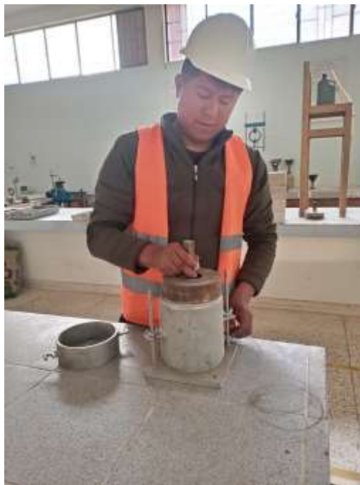
Fotografía 12. Preparación de molde + muestra para inversión, prueba CBR
