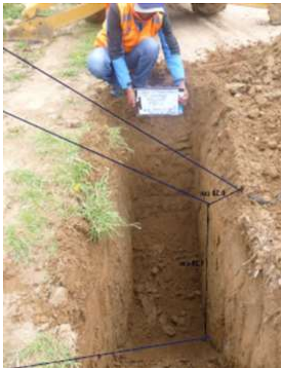
Fotografía 2. Calicata de muestra de suelo para hacer pruebas de laboratorio.
