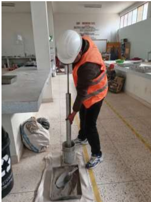
Fotografía 10. Compactación de material en capas para CBR
