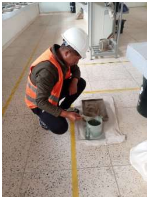
Fotografía 8. Llenado de material en capas para compactación con pisón
