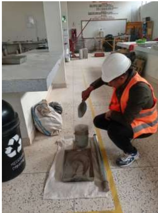
Fotografía 11. Colocación de material en molde y apisonado para prueba CBR
