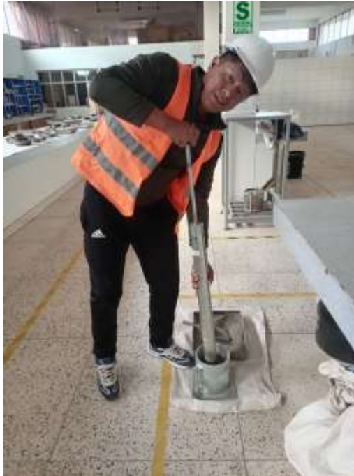
Fotografía 9. Compactación de capas con pisón
