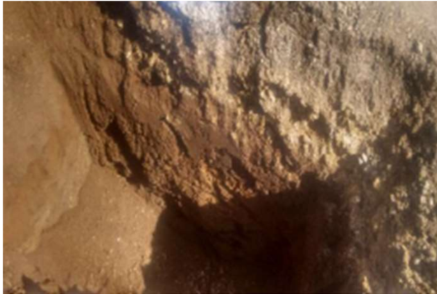
Fotografía 1. Calicatas sacando muestra del suelo inalterada.
